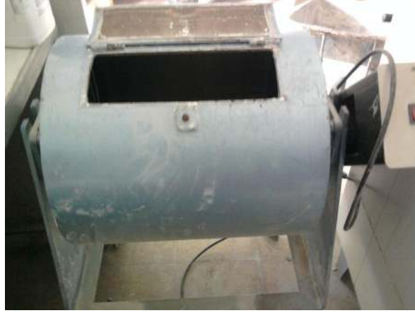
Resim 3.1 Malzemelerin öğütülmesinde kullanılan laboratuvar tipi bilyeli değirmen.
