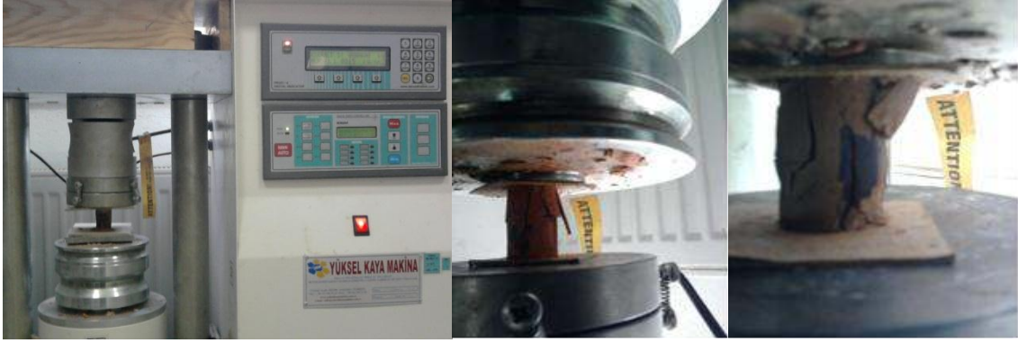
Resim 3.8 200 KN’luk kontrollü otomatik basınç presinde numunelerin kırılma işlemi.
