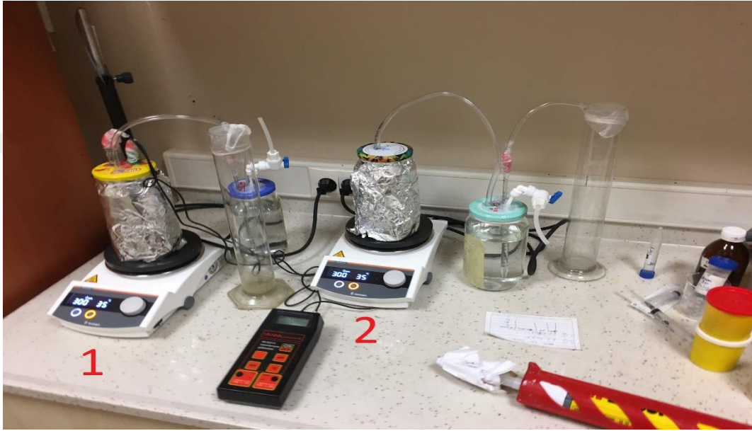
řekil 3.3. Biyogaz Üretimi İçin Tasarlanan Deney Düzeneęi
