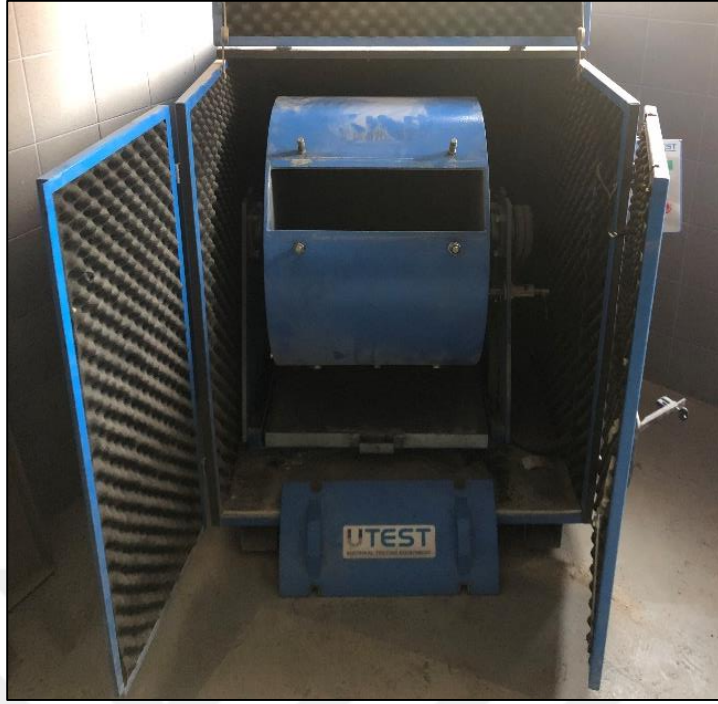
Şekil 3.4. Parçalanma dayanımı deney aleti
