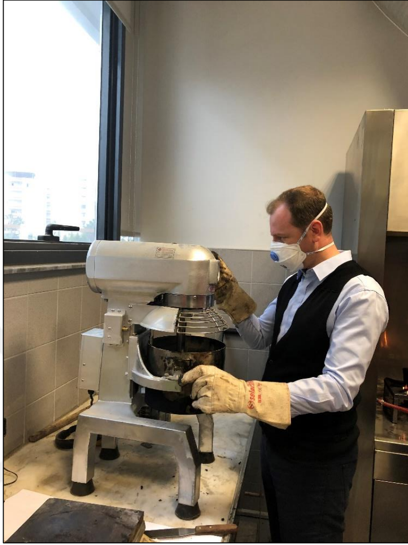
Şekil 3.18. Mekanik karıştırıcıyla karışımın hazırlanması
