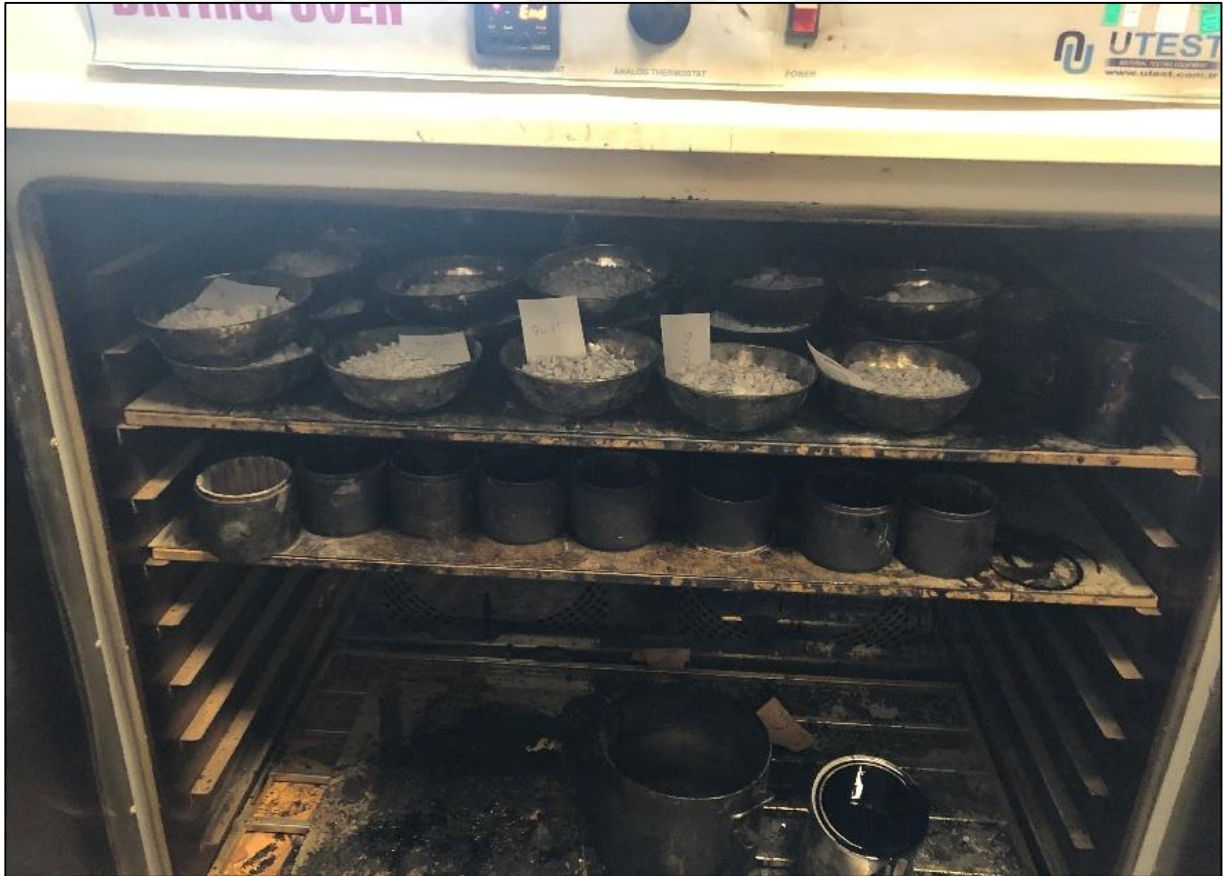
Şekil 3.17. Etüvde karışım için önceden ısıtılan deney numuneleri
