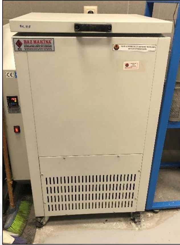
Şekil 3.5. Magneztum sülfat deneyi cihazı
