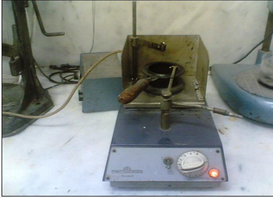
Şekil 3.15. Parlama noktası deney aleti
