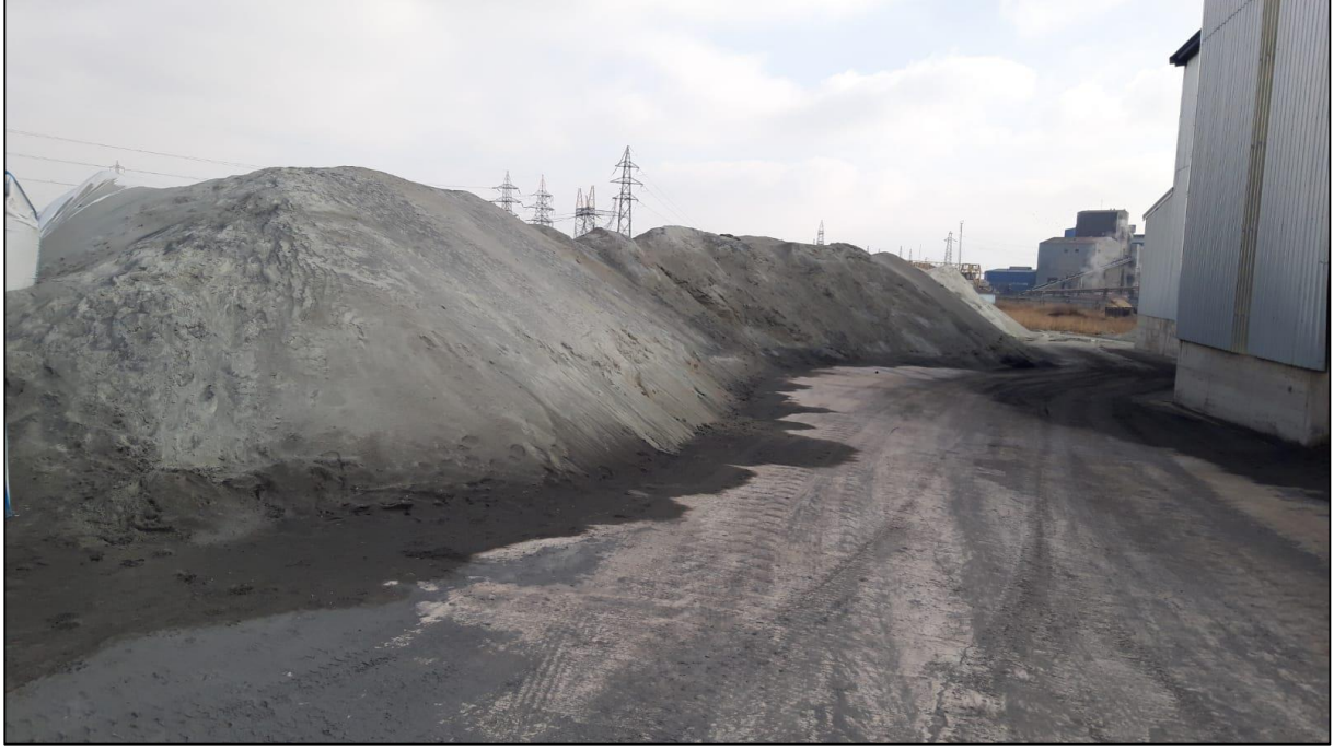
Şekil 3.2. Eti Krom tesislerinde atık olarak depolanan olivinden görüntü
