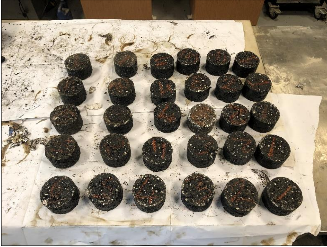
Şekil 3.19. Marshall briketi numuneleri
