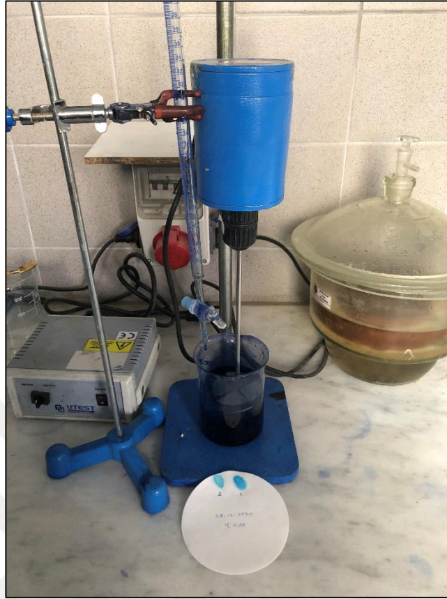
Şekil 3.11. Metilen mavisi deneyi
