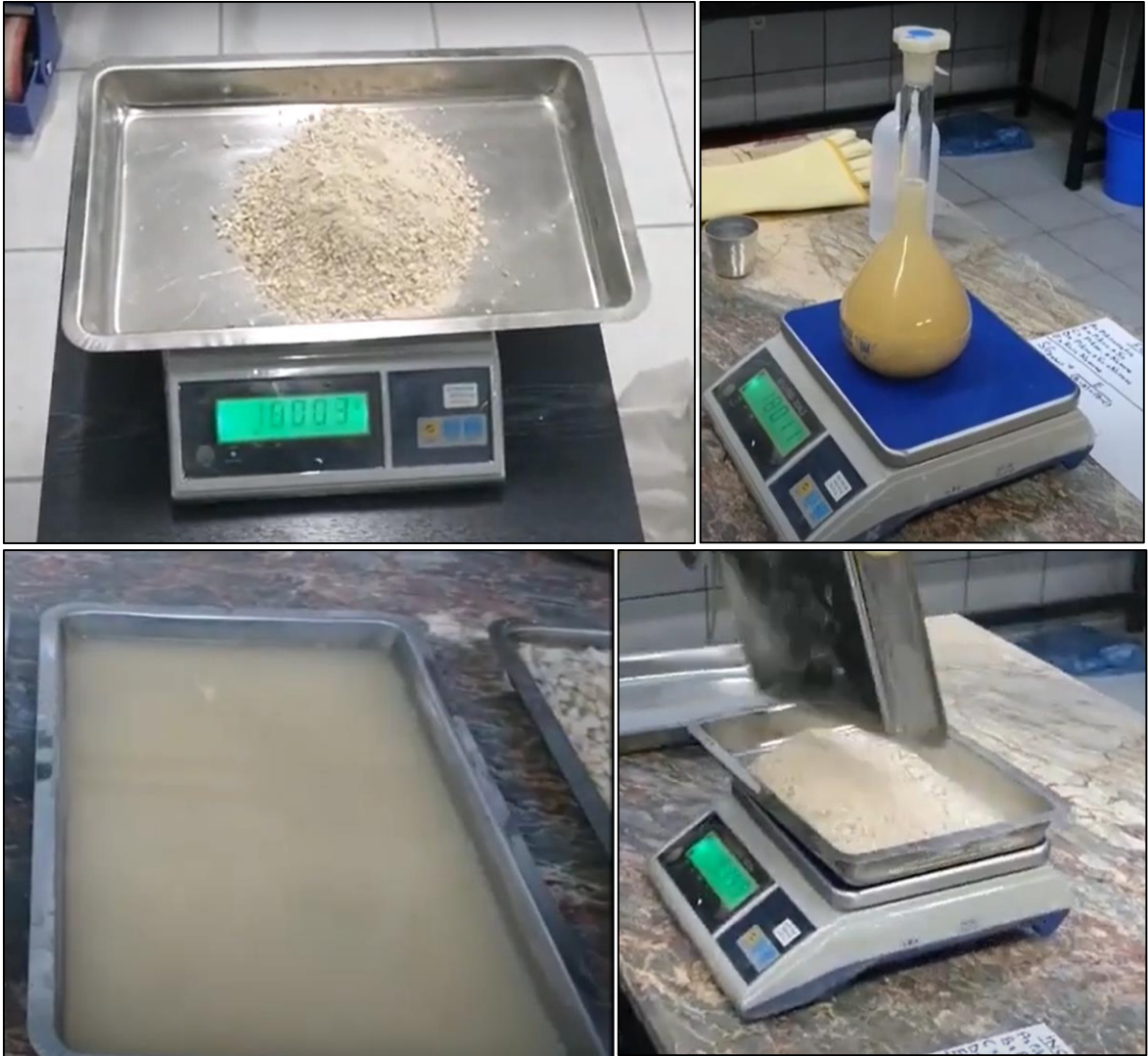
Şekil 3.8. İnce agreganın özgül ağırlık deneyi
