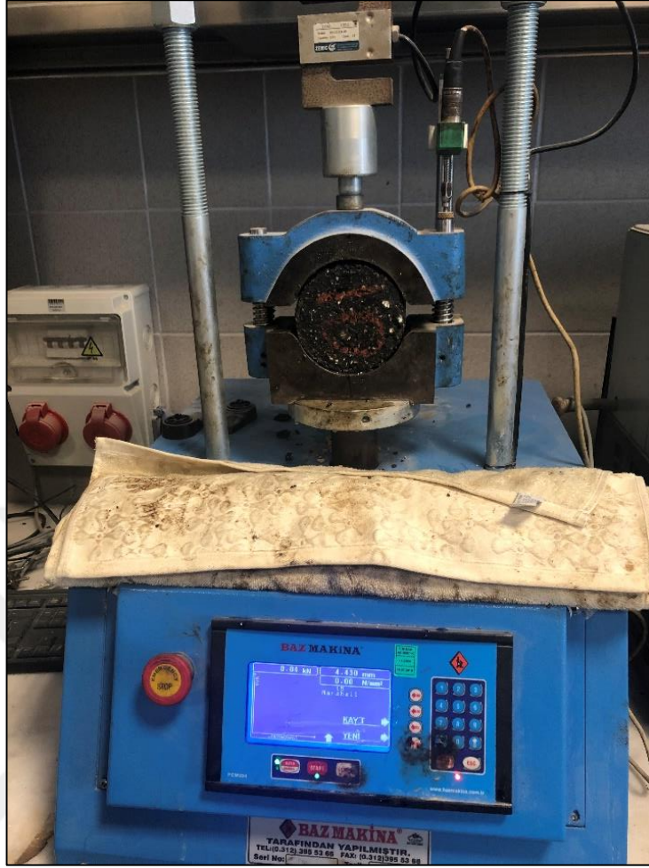
Şekil 3.20. Marshall stabilite ve akma deney aleti
