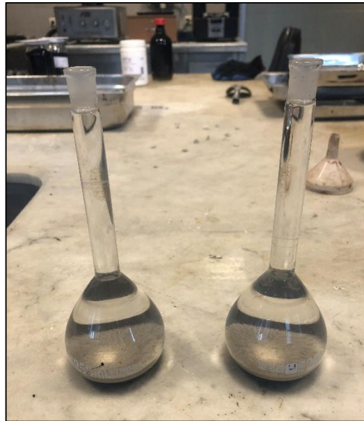
Şekil 3.9. Piknometre ile filler malzemenin özgül ağırlığı tayini
