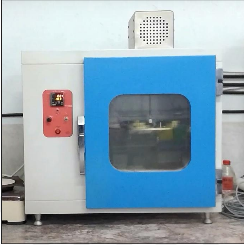
Şekil 3.14. İnce film deneyi dönel tablalı etüv
