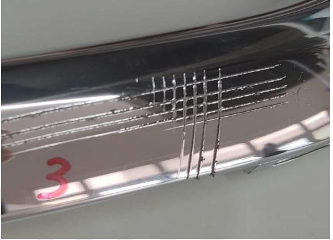
Şekil 5.30. Cross-Cut yapıp, yapıştırılan bandın çekilmesinden hemen sonra 3. deney numunesinin fotoğrafı
