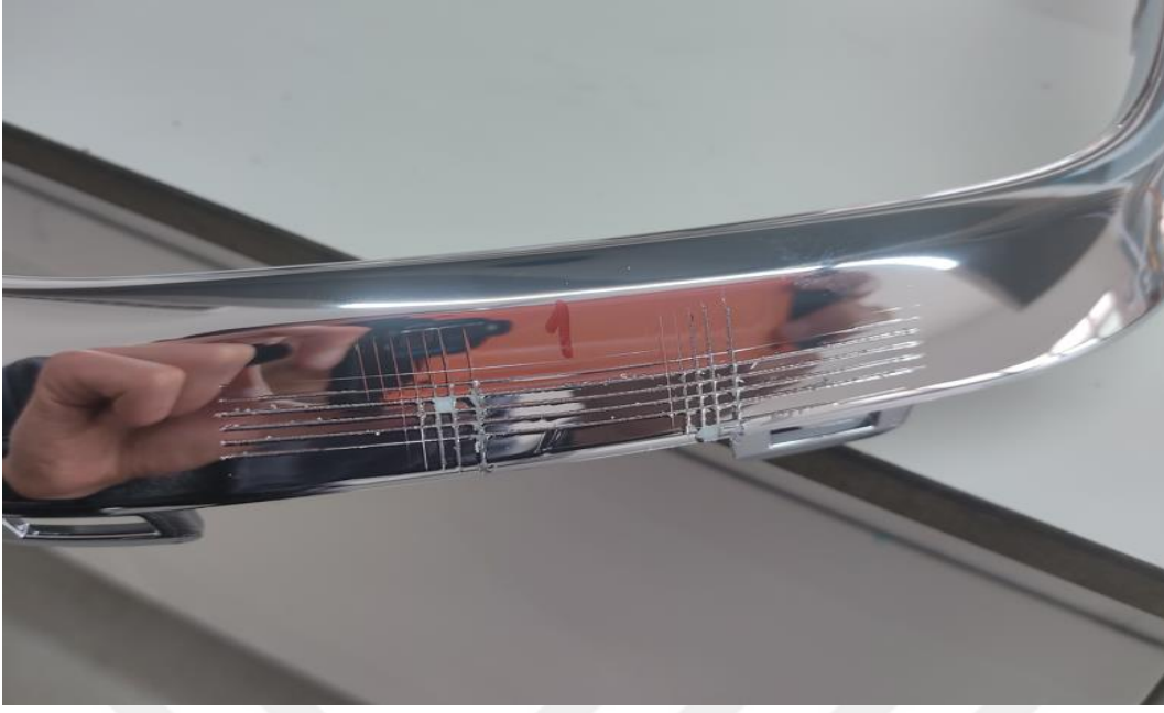
Şekil 5.28. Cross-Cut yapıp, yapıştırılan bandın çekilmesinden hemen sonra 1. deney numunesinin fotoğrafı
