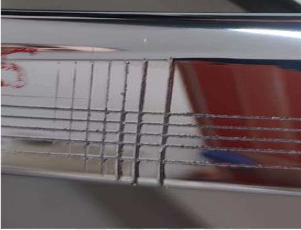
Şekil 5.32. Cross-Cut yapıp, yapıştırılan bandın çekilmesinden hemen sonra 5. deney numunesinin fotoğrafı
