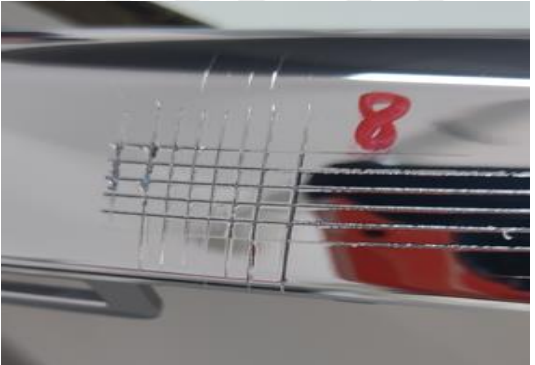
Şekil 5.35. Cross-Cut yapıp, yapıştırılan bandın çekilmesinden hemen sonra 8. deney numunesinin fotoğrafı
