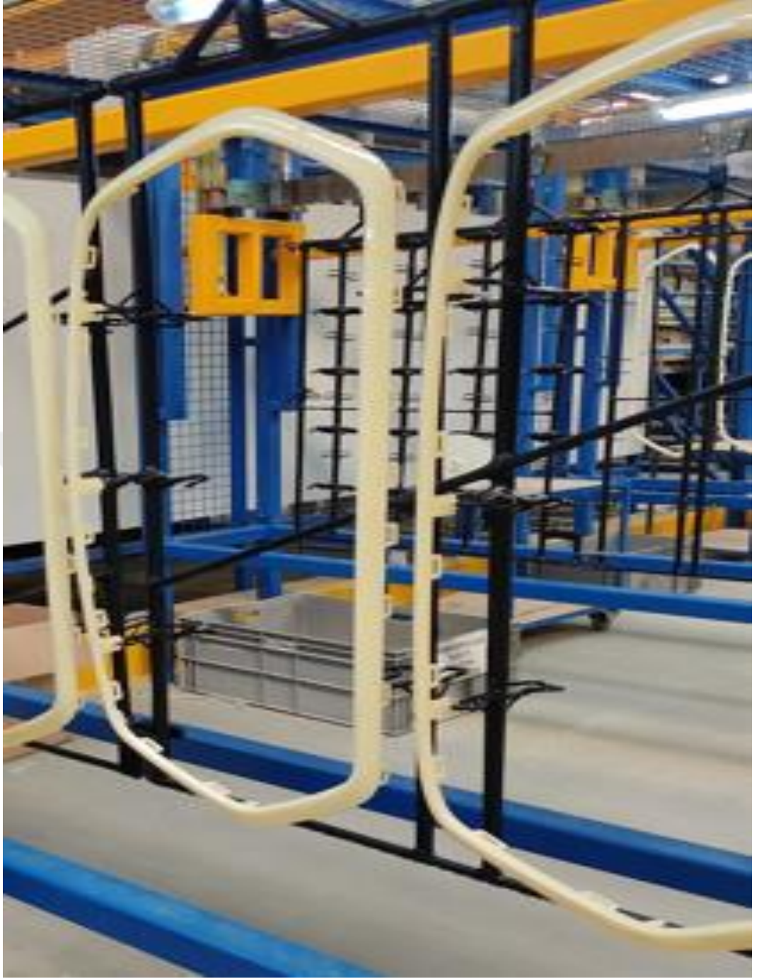
Şekil 4.11. Parçalar banyolara girmeden önce baralara (askı platformu) asılır
