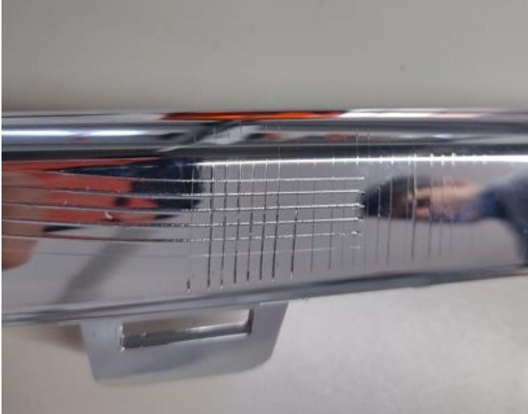
Şekil 5.45. Isıl Çevrim testinin ardından Cross-Cut yapıp, yapıştırılan bandın çekilmesinden hemen sonra 9. deney (seri üretim) numunesinin fotoğrafı
