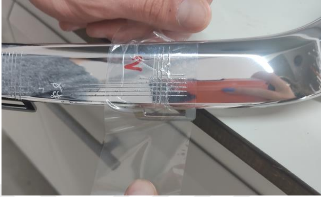
Şekil 4.38. Cross-Cut yapıp, bant yapıştırılan 2. deney numunesinin fotoğrafı
