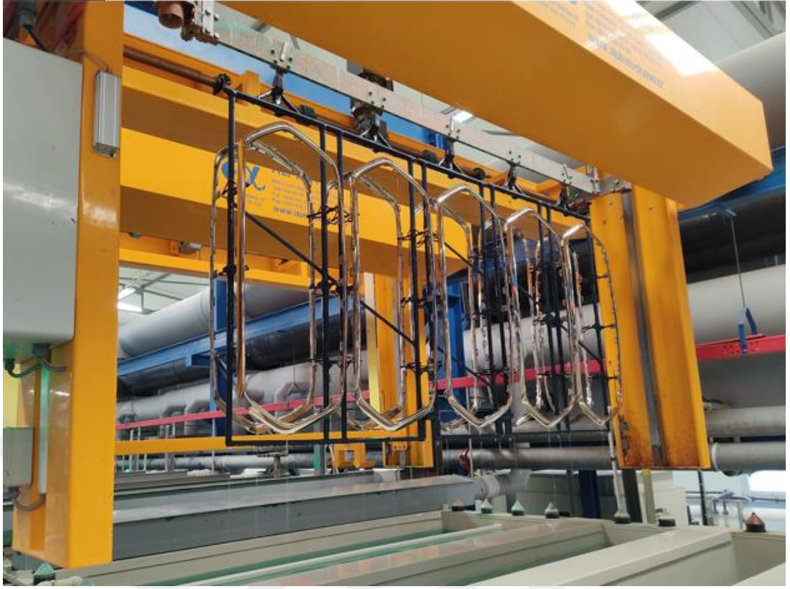
Şekil 4.27. Mikroçatlak Nikel Yıkama banyosu sonrası
