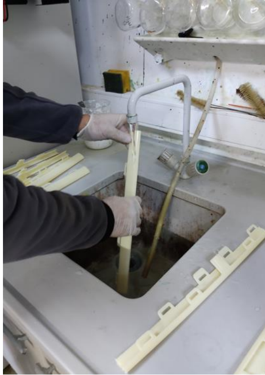
Şekil 4.33. Parçaların stres testinden sonra su ile yıkınışı
