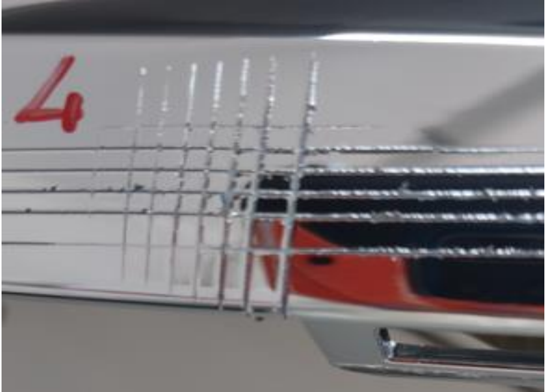
Şekil 5.31. Cross-Cut yapıp, yapıştırılan bandın çekilmesinden hemen sonra 4. deney numunesinin fotoğrafı
