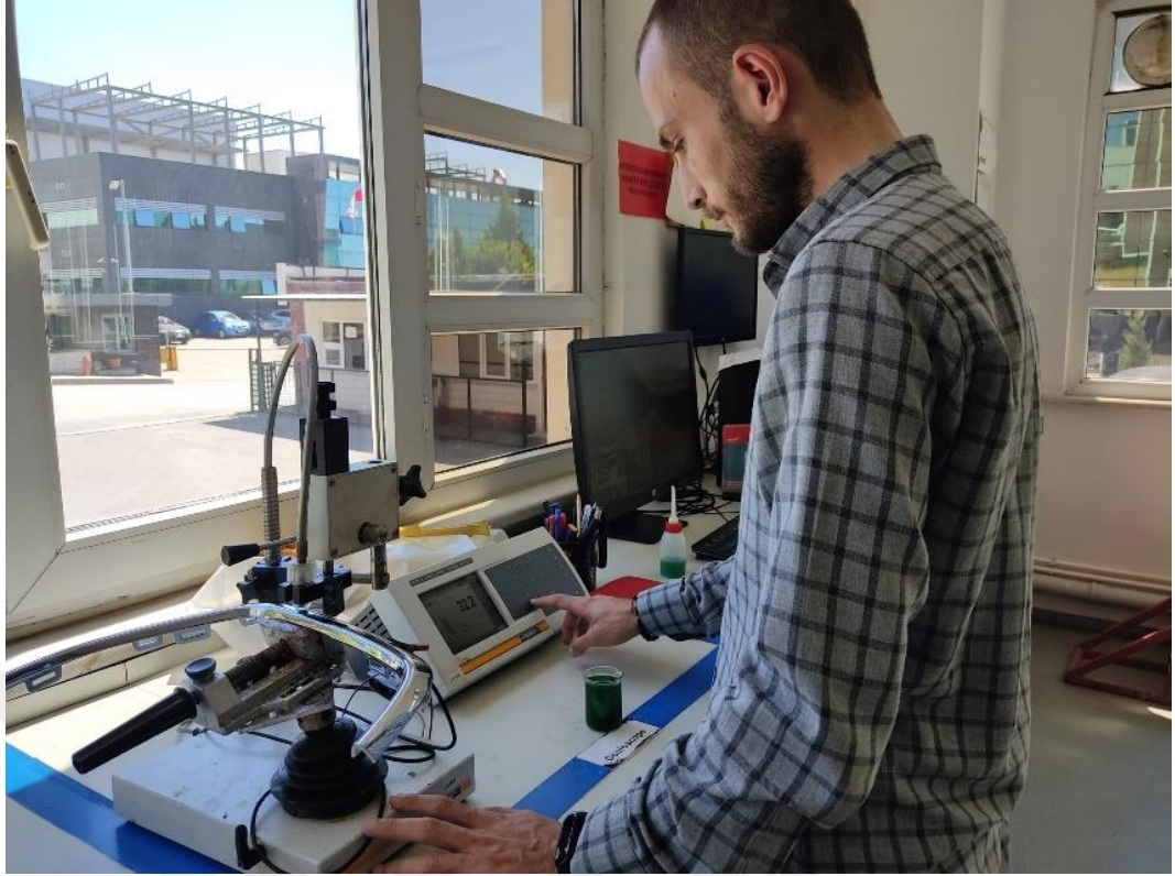
Şekil 4.41. Kaplama kalınlıları ölçülürken
