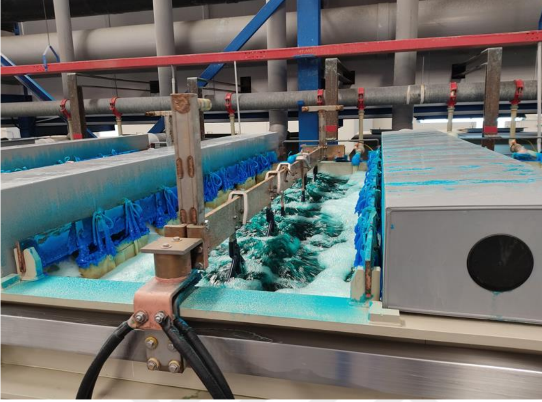
Şekil 4.25. Parçaların asılı olduğu bara Asit Bakır banyosunda
