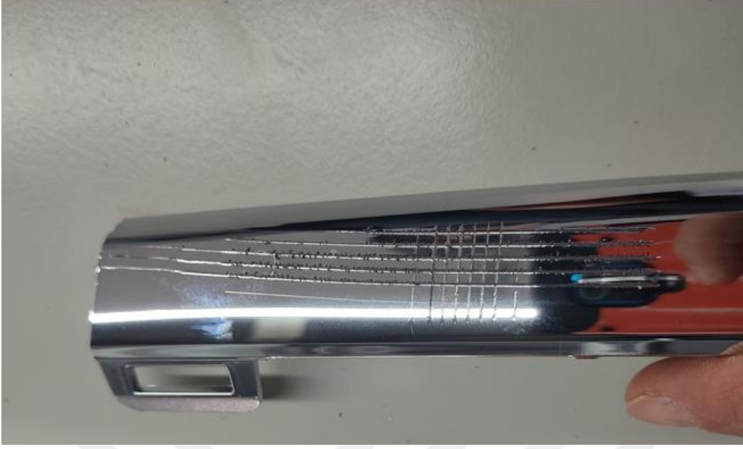
Şekil 5.44. Isıl Çevrim testinin ardından Cross-Cut yapıp, yapıştırılan bandın çekilmesinden hemen sonra 8. deney numunesinin fotoğrafı
