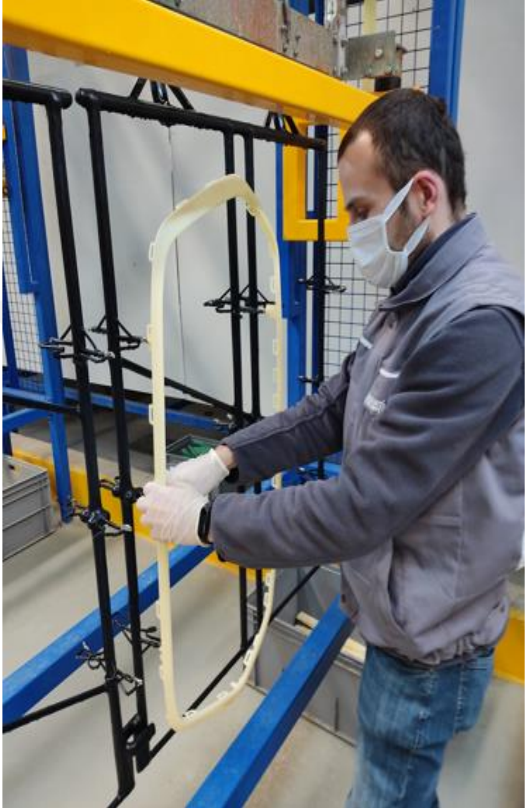
Şekil 4.13. Aşındırma + Yıkama banyolarından sonra parçaların baralardan sökülmesi
