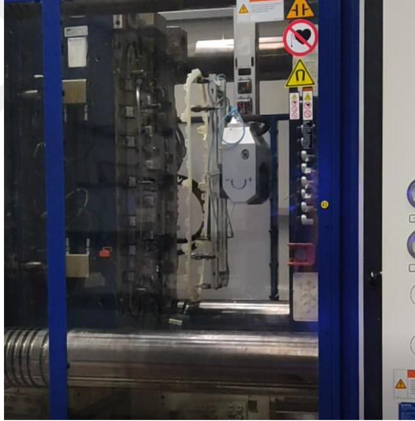
Şekil 4.6. Robotun parçayı alması
