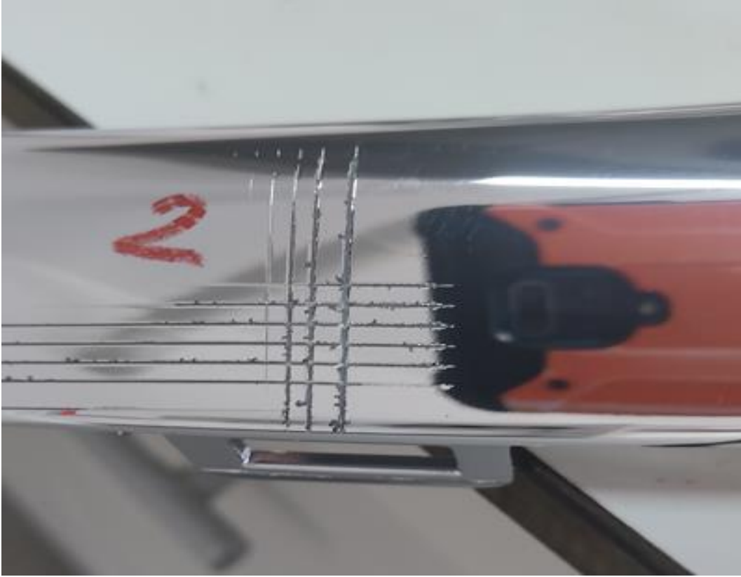
Şekil 5.29. Cross-Cut yapıp, yapıştırılan bandın çekilmesinden hemen sonra 2. deney numunesinin fotoğrafı
