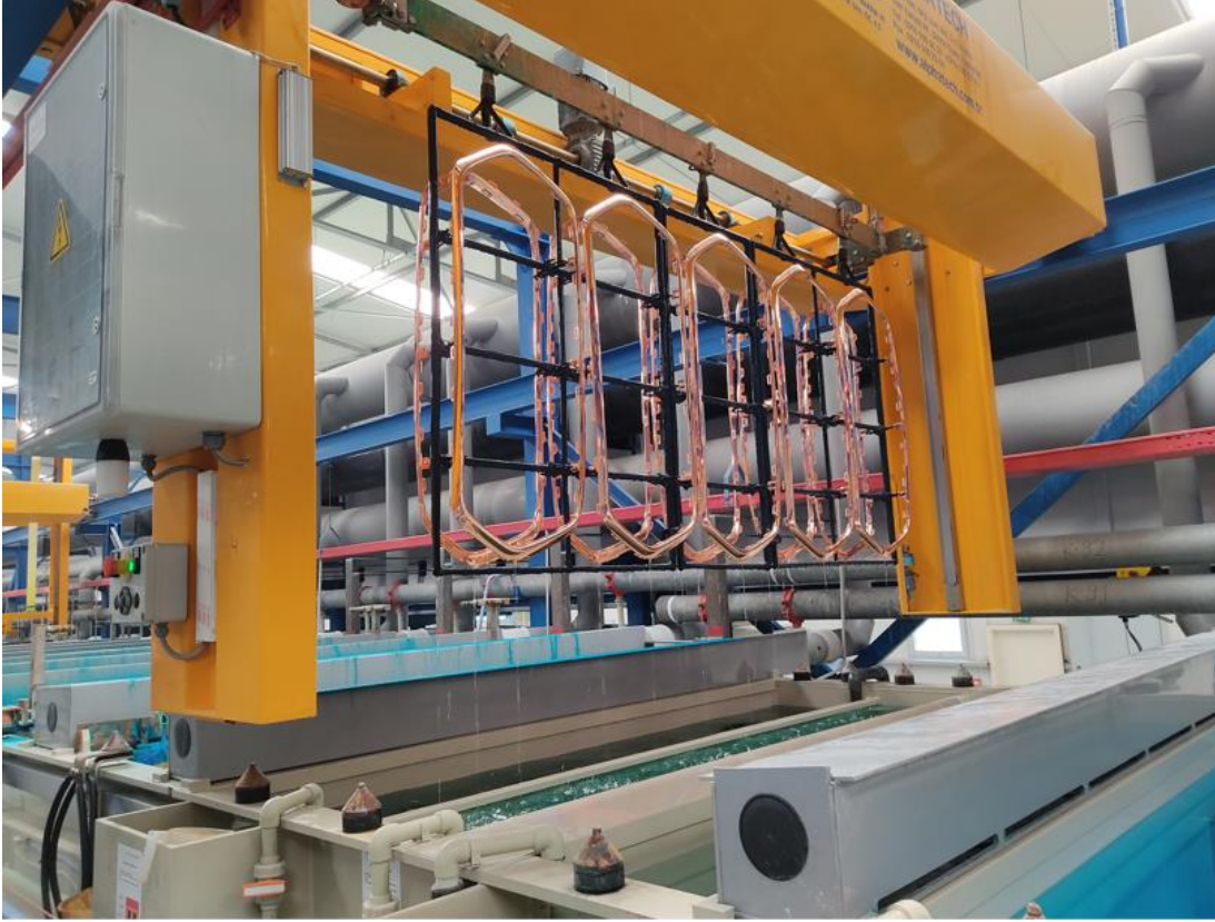
Şekil 4.26. Asit Bakır Yıkama banyosu sonrası
