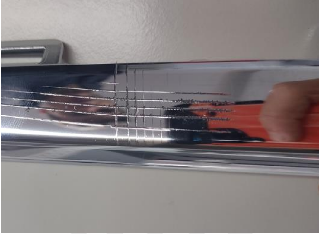
Şekil 5.40. Isıl Çevrim testinin ardından Cross-Cut yapılıp, yapıştırılan bandın çekilmesinden hemen sonra 4. deney numunesinin fotoğrafı
