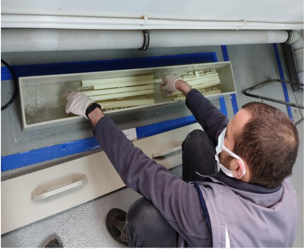
Şekil 4.32. Parçaların soğuk asedik asit havuzuna bırakılışı
