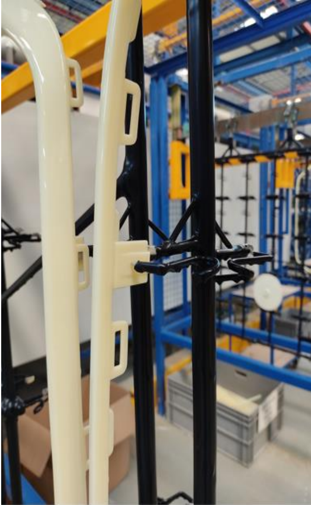
Şekil 4.12. Parçalar baralara kısıkaçlar ile banyolara daldırılıp çıkarılma esnasında kıpırdamayacak şekilde tutturulur
