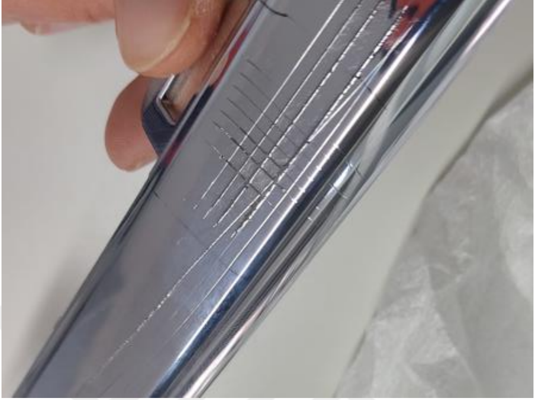
Şekil 5.38. Isıl Çevrim testinin ardından Cross-Cut yapıp, yapıştırılan bandın çekilmesinden hemen sonra 2. deney numunesinin fotoğrafı
