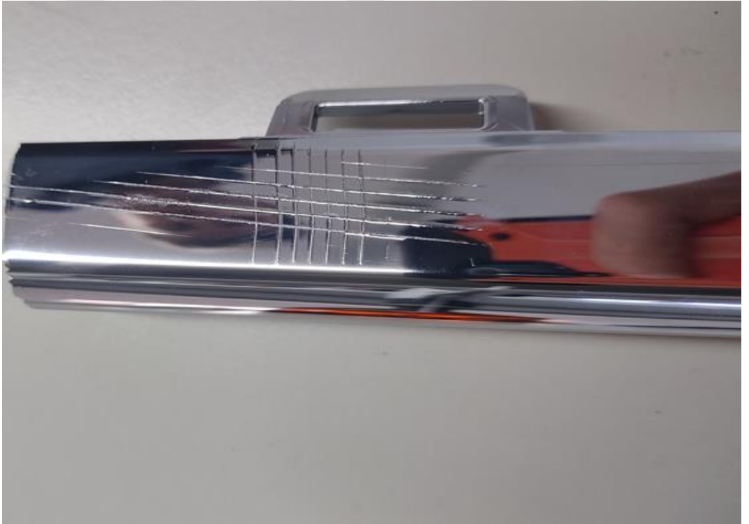
Şekil 5.39. Isıl Çevrim testinin ardından Cross-Cut yapıp, yapıştırılan bandın çekilmesinden hemen sonra 3. deney numunesinin fotoğrafı
