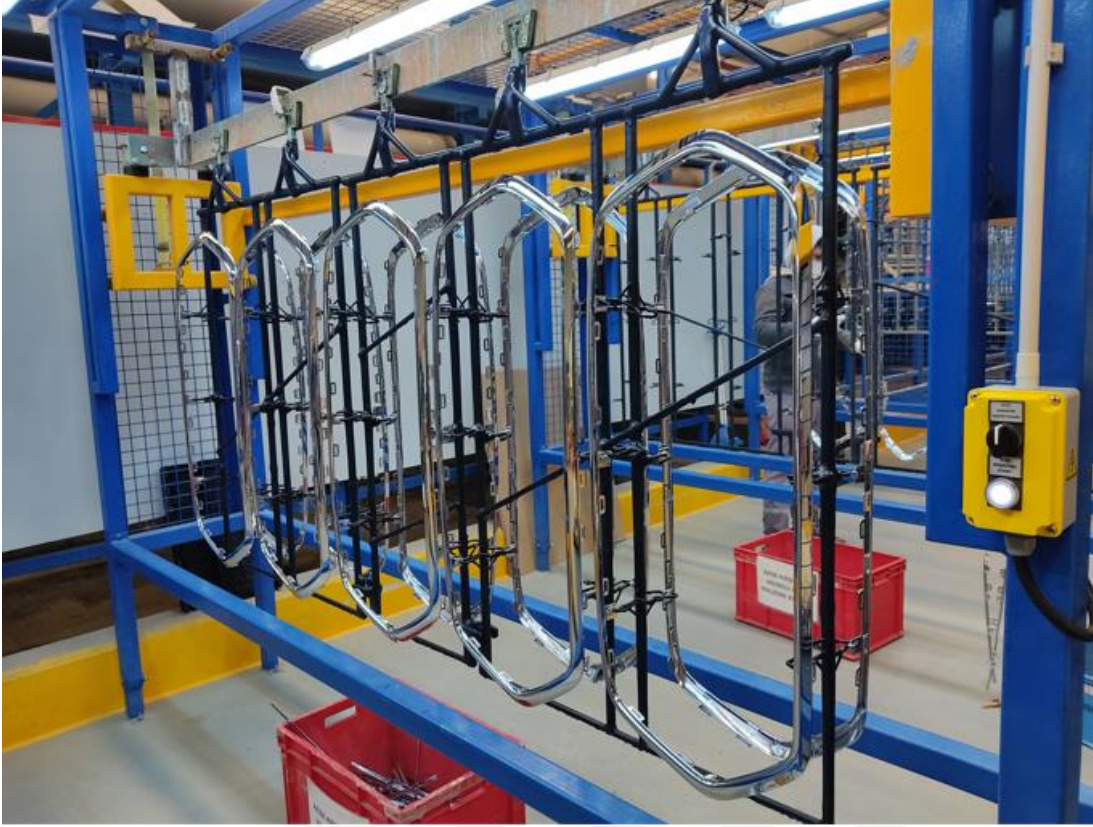
Şekil 4.29. Krom kaplama prosesi tamamlandıktan sonra parçaların son hali
