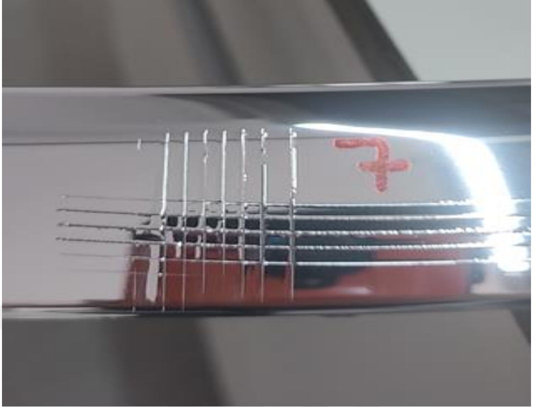
Şekil 5.34. Cross-Cut yapıp, yapıştırılan bandın çekilmesinden hemen sonra 7. deney numunesinin fotoğrafı
