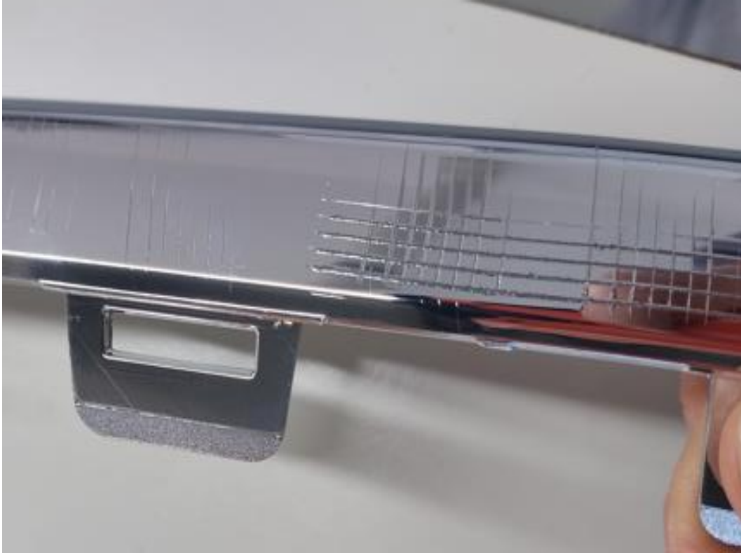
Şekil 5.41. Isıl Çevrim testinin ardından Cross-Cut yapılıp, yapıştırılan bandın çekilmesinden hemen sonra 5. deney numunesinin fotoğrafı
