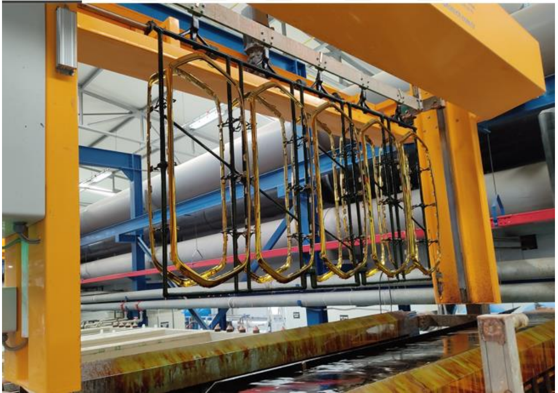
Şekil 4.28. Krom Aktivasyon banyosu sonrası
