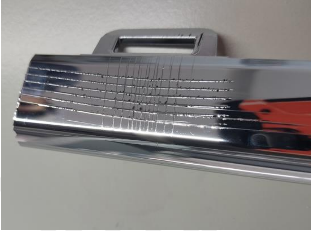
Şekil 5.42. Isıl Çevrim testinin ardından Cross-Cut yapılp, yapıştırılan bandın çekilmesinden hemen sonra 6. deney numunesinin fotoğrafı
