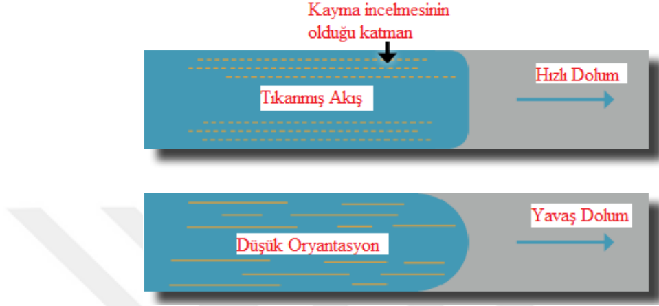
Şekil 1.10. Enjeksiyon hızının oryantasyona etkisi [13]
