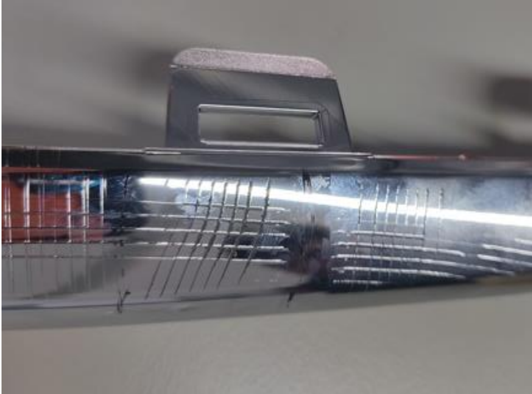
Şekil 5.37. Isıl Çevrim testinin ardından Cross-Cut yapıp, yapıştırılan bandın çekilmesinden hemen sonra 1. deney numunesinin fotoğrafı
