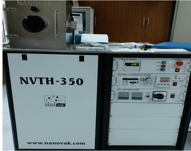
Şekil 2.5. Termal buharlaştırma (NVTH-350) sistemi (Batman Üniversitesi)
