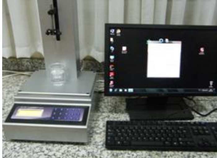
Şekil 3.1. Holmarck sol-jel daldırma kaplama cihazı
