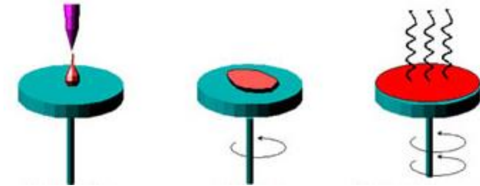
Şekil 2.9. Sol-jel döndürme metoduyla kaplama aşamaları
