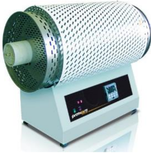
Şekil 3.2. 0-1200 °c ayarlanabilir protherm ptf 12/75/800 tüp fırın
