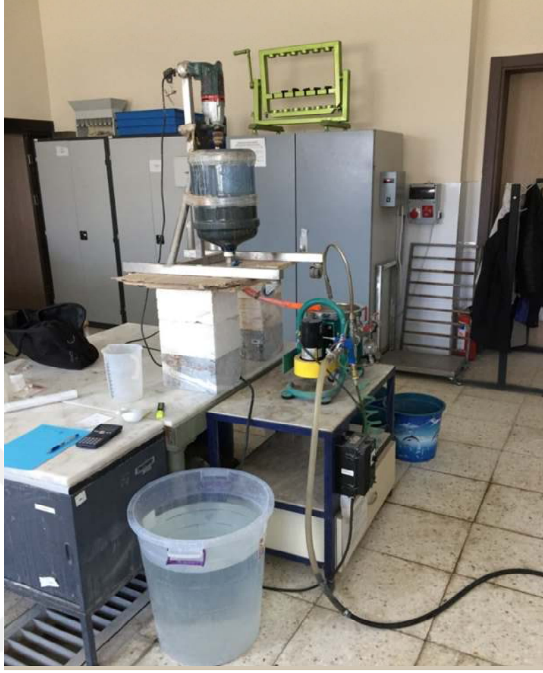
Şekil 2.8 Knelson Gravite Seperatörde çalışma düzeneği.
