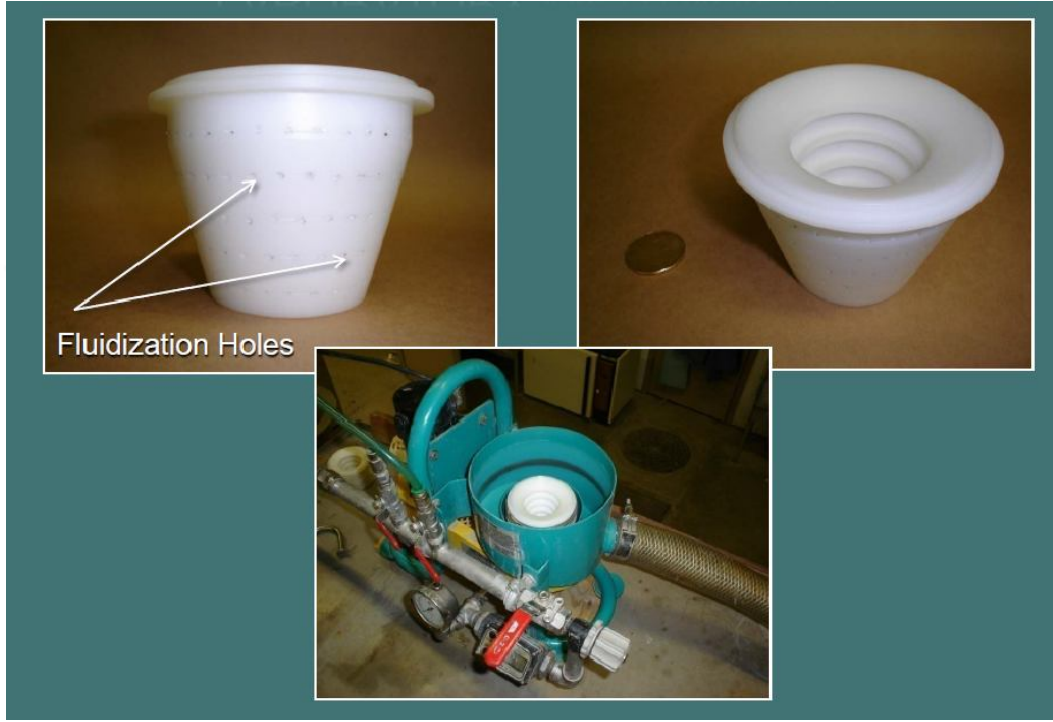
Şekil 2.4 Knelson Gravite Konsantratör görseli ve çanak yapısı.
