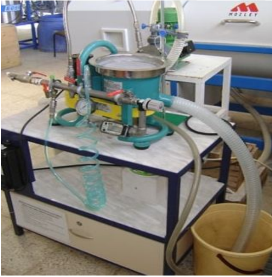
Şekil 2.7 Deneylerde kullanılan laboratuvar tip Knelson Gravite Seperator (MD3 Model).
