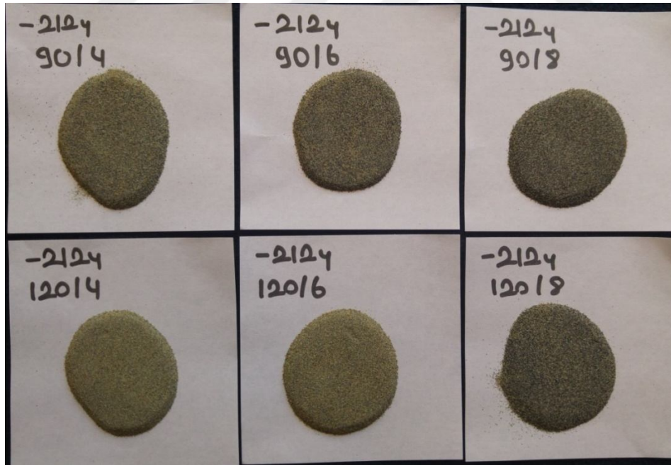
Şekil 4.6 - 212 \mu 90 ve 120 G' de KGS deney sonuçlarının karşılaştırmalı görünüm.
