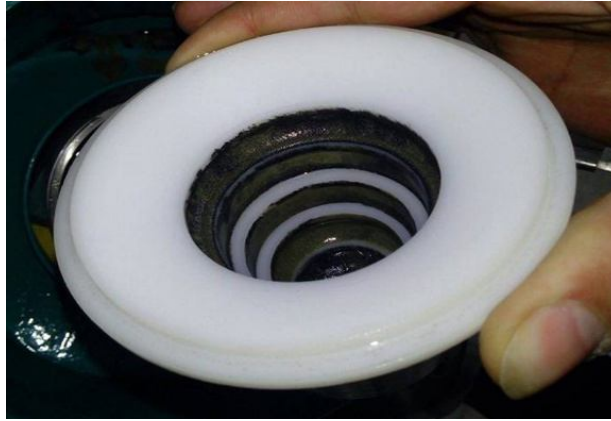
Şekil 4.1 Knelson Gravite Konsantratör çanağında biriken krom görseli.
