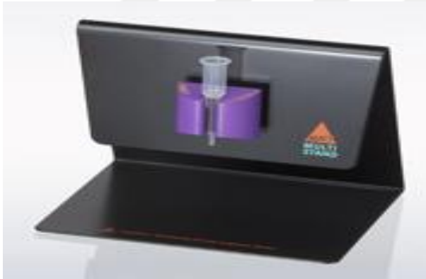
Şekil 17: Manyetik partiküller ile ayırmada kullanılan magnet.
