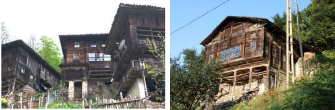
Şekil 5. Taş kagir üzeri ahşap yığma duvarlar (Faiz Büyükçam, 2021; Karadeniz fotoğraf arşivi, 2022)
