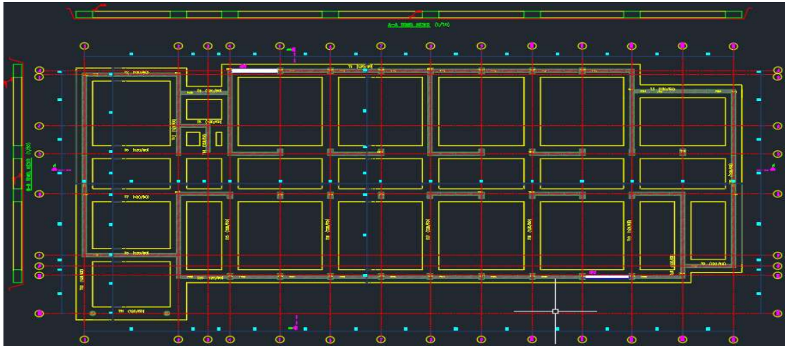
Şekil 4.27. Temel planı güçlendirilmiş durum
