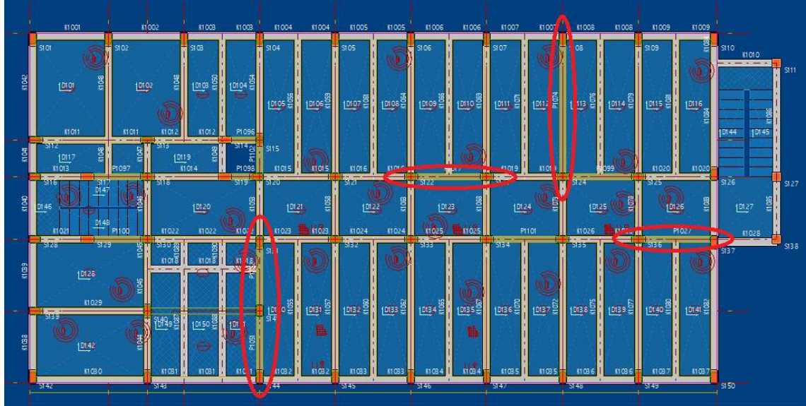
Şekil 4.60. Güçlendirme perdelerinin geleceği kısımlar (STA4CAD verileri)
