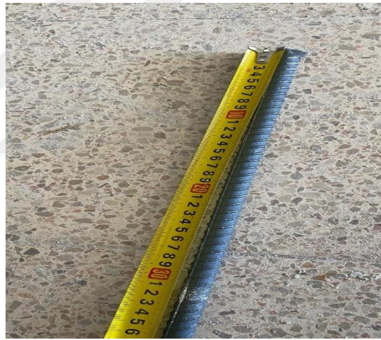
Şekil 4.106. Ankraj delikleri uzunluğunun projeye uygunluğunun ölçülmesi
