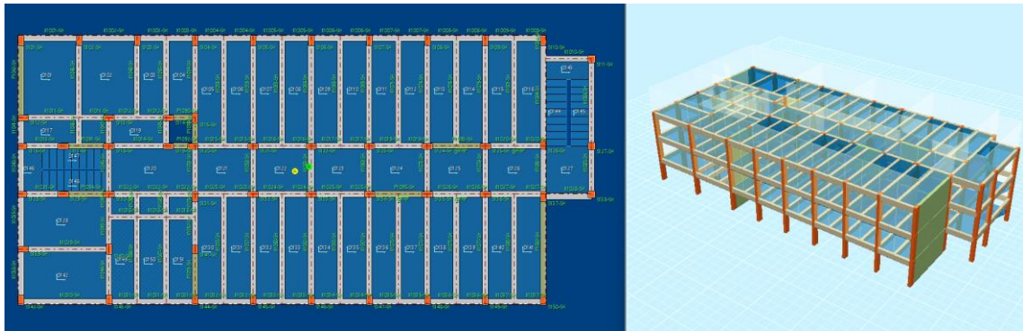
Şekil 4.74. Güçlendirme-3 sonrası analiz (STA4CAD verileri)
