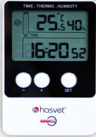
Şekil 3. 1. İklimsel verilerin alınmasında kullanılan Data logger cihazı
