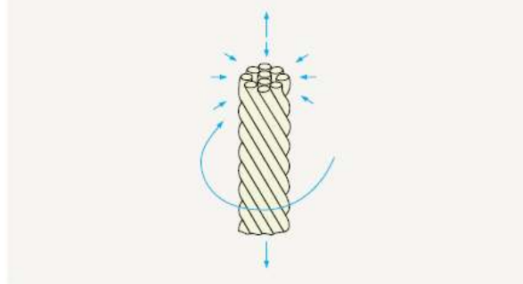
Şekil 3.52. Büküm ile İpliğe Mukavemet Sağlanması (Klein, 2014)
