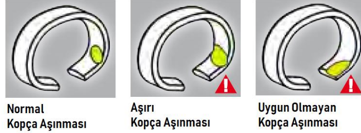
Şekil 3.28. Kopça Üzerindeki Aşınma (Bräcker, 2008)
