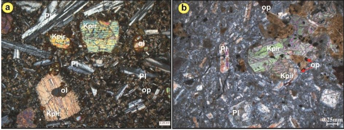
Şekil 3. 5. Bazaltik (a ve b) bileşimli volkanik breş çakıllarının mikroskobik görünümü. (a) Hyalo-mikrolitik porfirik dokulu bazaltik breş içerisindeki klinopiroksen, iddingsitleşmiş olivin ve plajiyoklaslar, (b) albit ikizlenmesi gösteren plajiyoklas mineralleri ve opak mineral içeren klinopiroksen fenokristali (Örnek No: N-22) (Ç.N.; Kpir:Klinopiroksen, Pl:Plajiyoklas, ol: olivin, op: Opak mineral).
