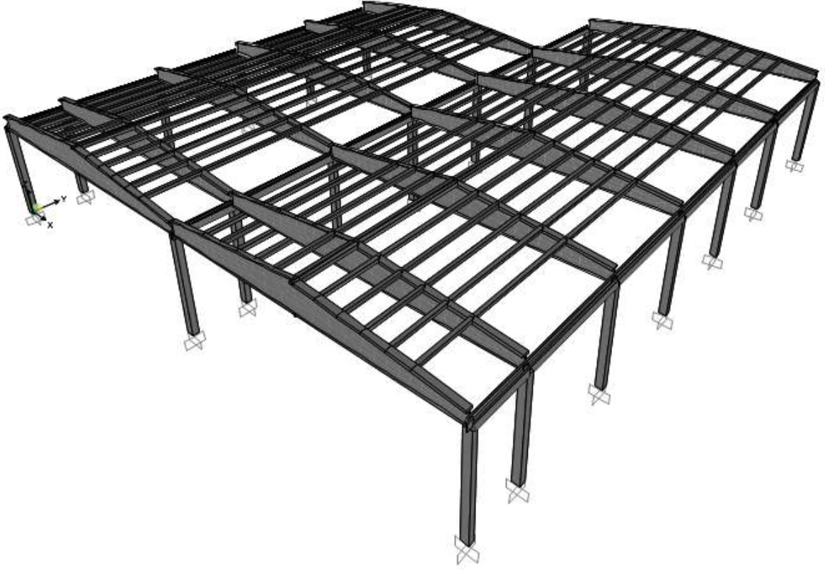
Şekil 2.31. Prefabrik yapının üç boyutlu sonlu elemanlar modeli
