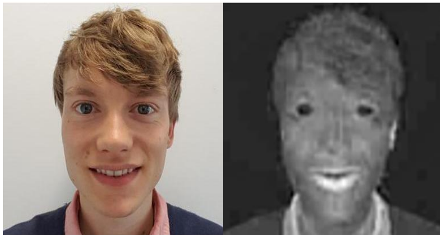
Şekil 3.24. Konvolüsyon işlemi sonucu ilgili çekirdeğin kırmızı renge duyarlı olduğunu gösteren örnek konvolüsyon çıktısı [121].
