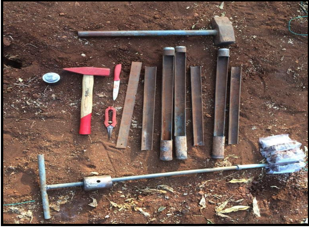
Şekil 3.10. Kök örneklemesinde kullanılan aletler
