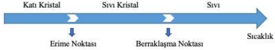
Şekil 2.5. Termotropik sıvı kristallerde faz geçişinin sıcaklığa bağlı gösterimi.
