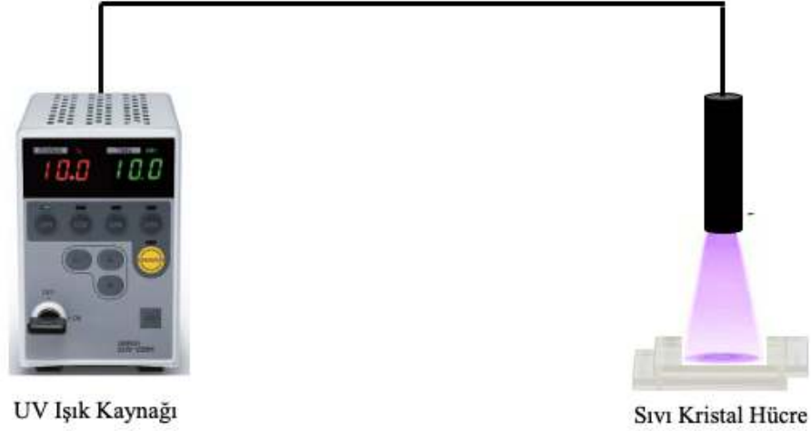
Şekil 5.3. Örneklerin UV ışık ile polimerizasyonunun şematik gösterimi.
