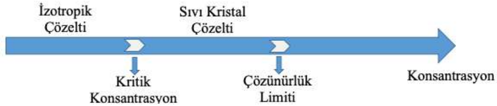
Şekil 2.9. Liyotropik sıvı kristallerde faz geçişinin konsantrasyona bağlı gösterimi.
