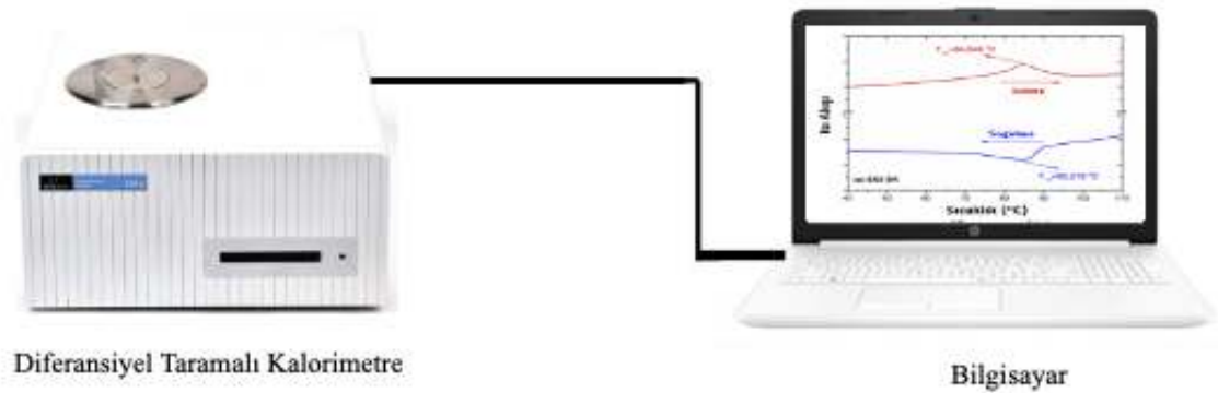
Şekil 5.6. Termal ölçümler için kullanılan deney düzeneği.
