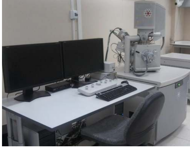
Şekil 5.7. Hazırlanan saf ve katkılı numunelerin morfolojik analizi için kullanılan SEM cihazı.
