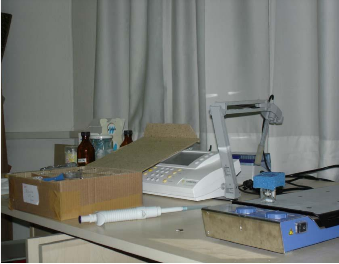
Şekil 3.2 Kristalin manyetik karıştırıcıda çözelti ile etkileştirilmesi
