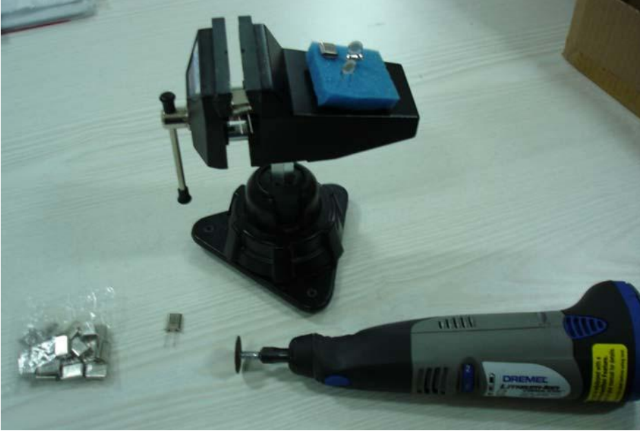
Şekil 3.1 Kristallerin Dremel 10.8V Lithium Ion el aletiyle metal başlıklarının kesilip çıkarılması
