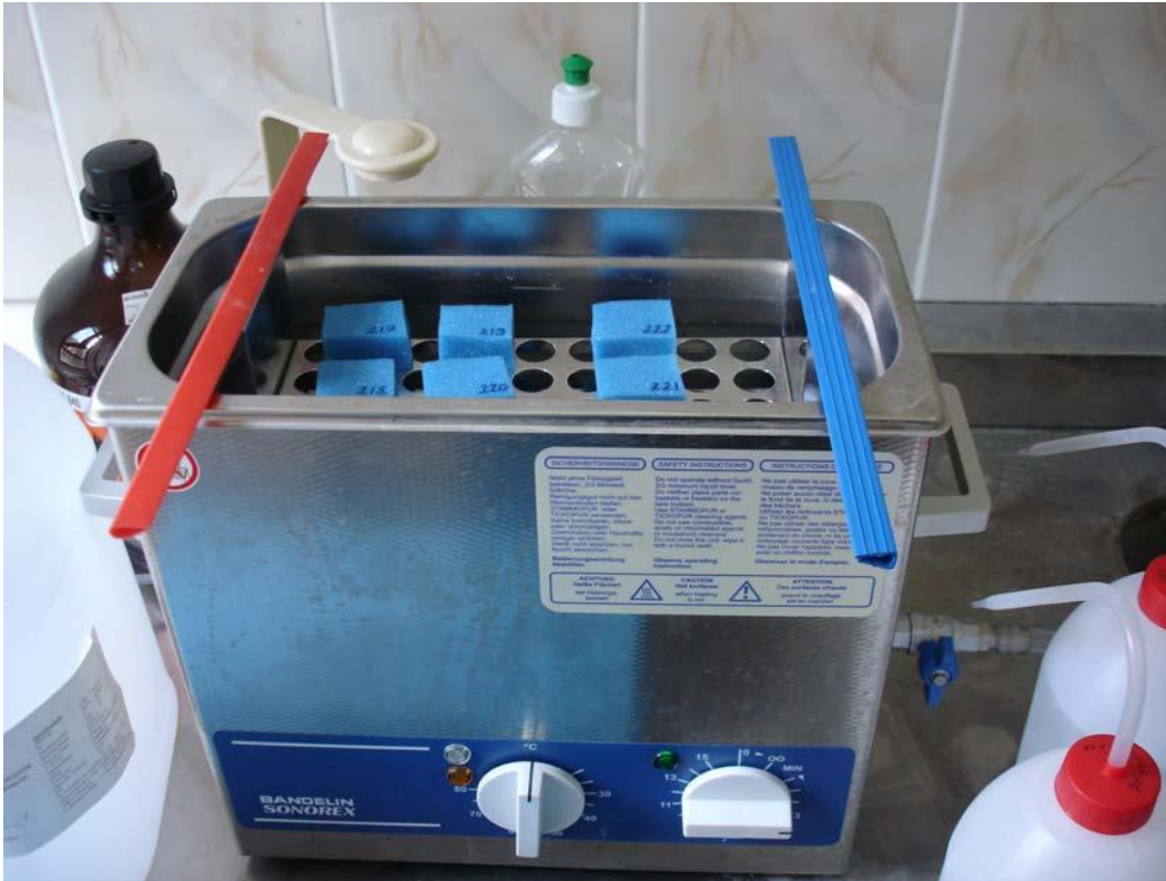
Şekil 3.4 Kristallerin ultrasonik banyoda deiyonize su ile yıkanması
