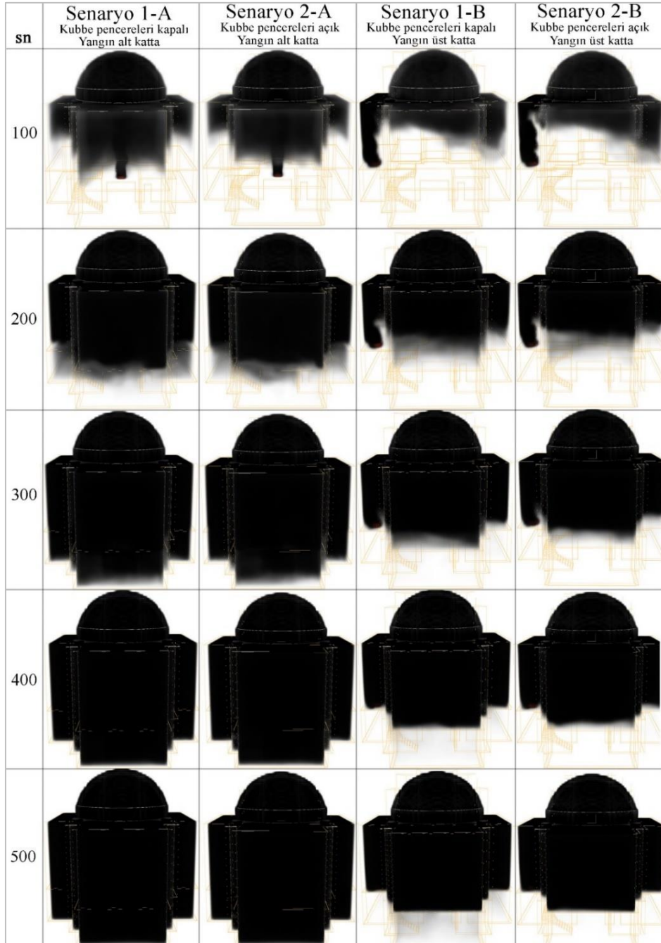
Şekil 4.2. Senaryolara ve zamana göre perspektif görüntüsünde duman dağılımı
