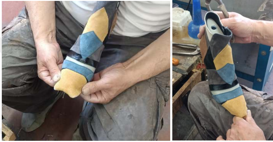
Şekil 5.23. Saya Formunun Kalına Uygun Hale Getirilme Süreci (Manuel Yerleştirme ve Gerdirme Uygulaması)
