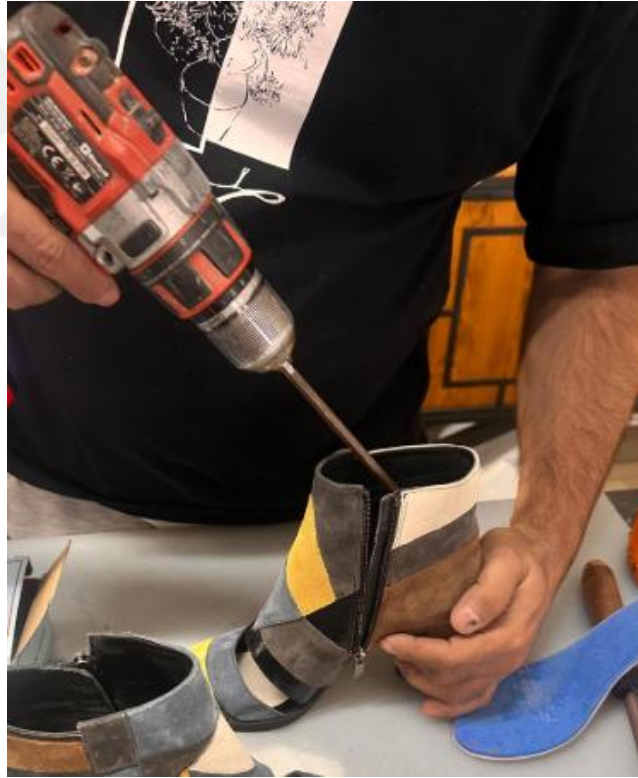
Şekil 5.27. İç taban destek parçasının topuk bölgesine matkap yardımıyla sabitlenme işlemi
