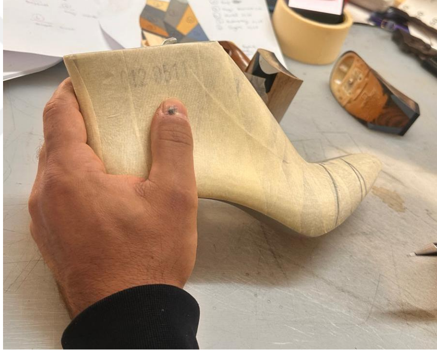
Şekil 5.18. İç Kalıp Üzerinden Istampa Çizimi
