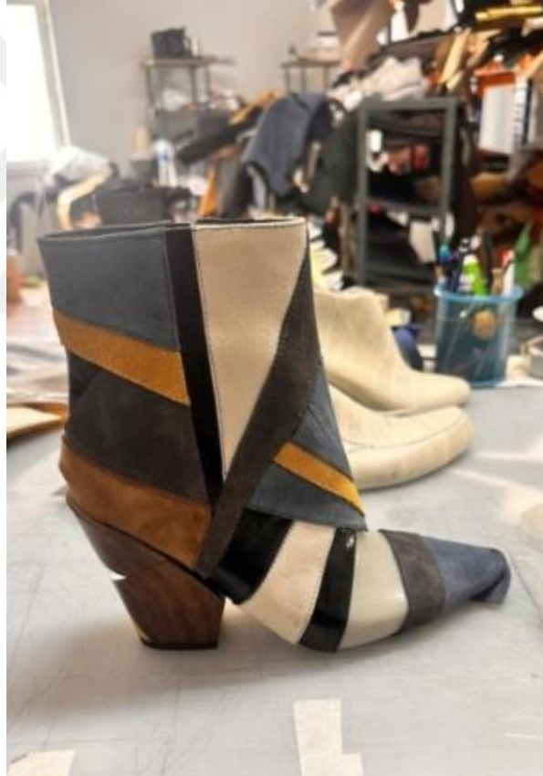
Şekil 5.22. Saya Kalıba Yerleştirilmiş ve Ökçe ile Uyum Kontrolü Yapılmış Montaj Aşaması
