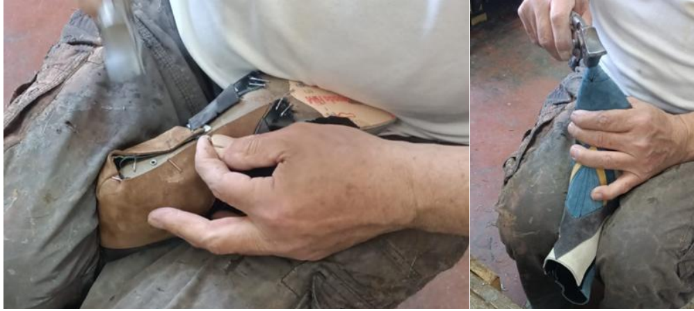
Şekil 5.24. Sayanın Kalına Yerleştirilerek Çivileme (Germe ve Sabitleme) İşlemi
