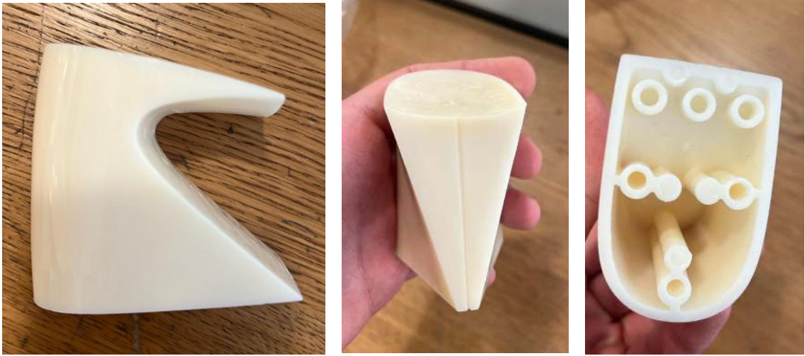
Şekil 5.12. Yazıcı Eşliğinde Üretilmiş Ökçe Prototipler ve Alt Görünümleri
