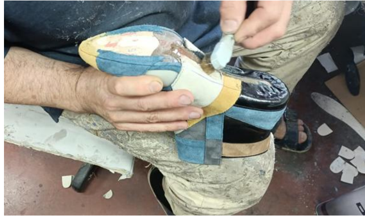
Şekil 5.25. Taban Birleştirme Öncesi Yapıştırıcı Uygulama Aşaması
