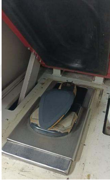
Şekil 5.26. Isıl Presleme, Makinesinde Taban-Saya Birleştirme Aşaması
