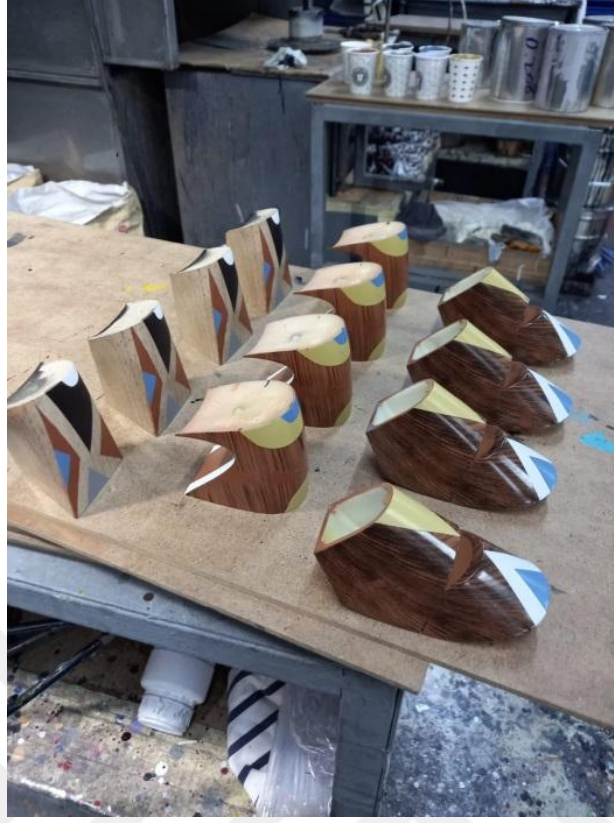
Şekil 5.15. Desen Uygulama, Boyama ve Vernikleme Süreci Tamamlanmış Nihai Topuk Prototipleri
