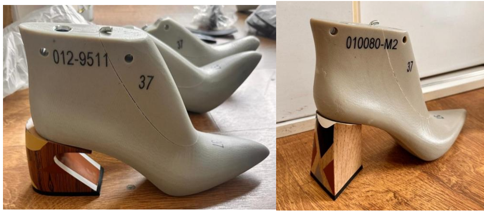
Şekil 5.17. İç Kalıpların Özgün Topuk Tasarımlarıyla Uyum Testi Süreci
