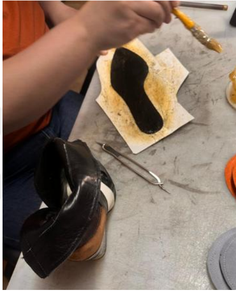
Şekil 5.28. Mostra Parçasına Yapıştırıcı Uygulanması Aşaması
