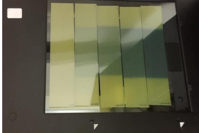
Şekil 3.18. Kalibrasyon filmlerinin tarayıcı konumlandırılması
