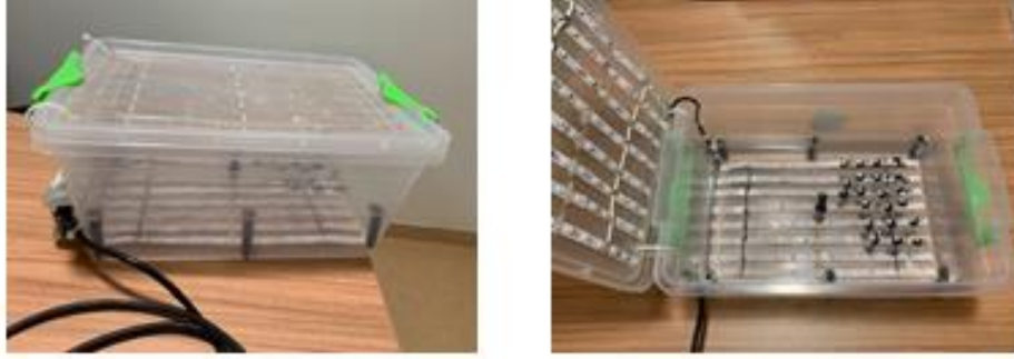
Şekil 3.3. OSL dozimetrelerini UV-ışınlarına maruz bırakmak için tasarlanan kutu (The Blue LED Box)
