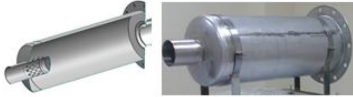
Şekil 4.4. Akış düzeltici tasarım ve imalatı
