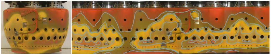
Şekil 5.8. Dış gömlek panoramik görüntüsü ve sıcaklık geçişleri
