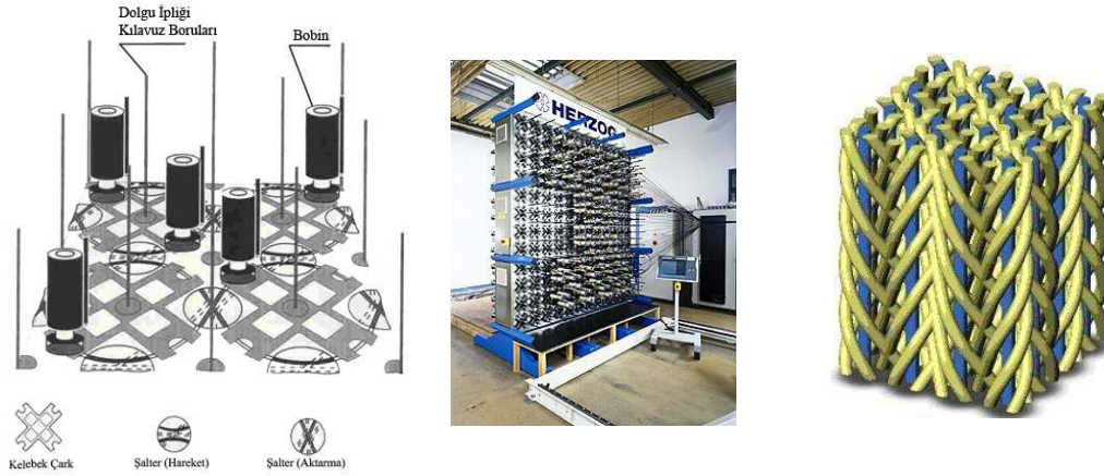
Şekil 1.10 Üç boyutlu rotasyon şerit örme prensibi (sol), makinesi (orta) ve örgü örneğinin geometrik şekli (sağ) (ITA, MYM Technologies Ltd., Herzog Brading Machines, b.t.).
