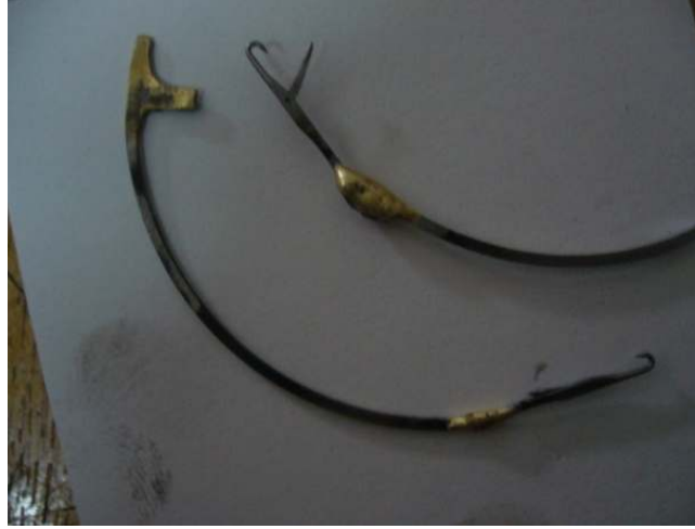
Şekil 4.42 Taşlandıktan sonra gümüş kaynağıyla uçları kaynatılan iğneler.
