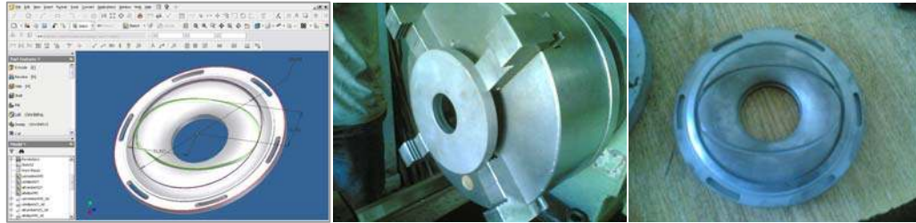
Şekil 4.31 Uzay kamının üretim aşamaları.
