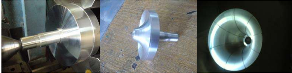
Şekil 4.30 7000 serisi (7075) alüminyum iğne silindiri.
