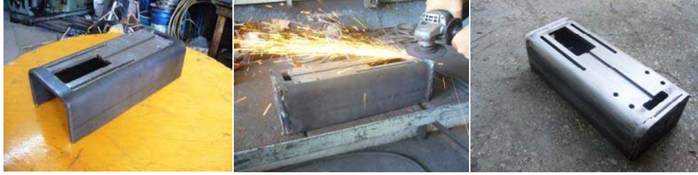
Şekil 4.32 Makine gövdesinin üretim aşamaları.
