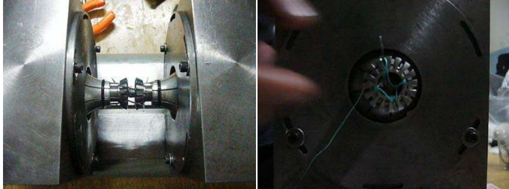
Şekil 4.43 Montajın ardından ilk örme kumaş oluşturulması.
