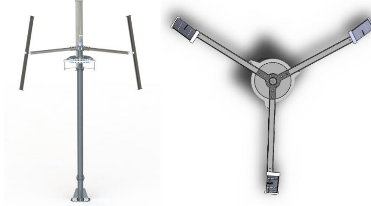
Şekil 3.18. İmalatı yapılan rüzgar türbininin yandan ve üstten görünümü
