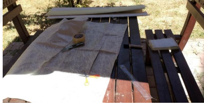
Şekil 3.26. Kanat yüzey boyutlarına göre cam elyaf malzemenin kesilmesi
