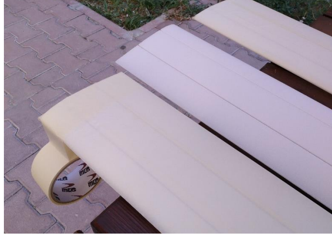
Şekil 3.25. Kanatçıkları kağıt bant ile kaplanması
