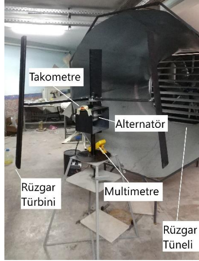
Şekil 4.1. Rüzgar tüneli ölçüm düzeneği
