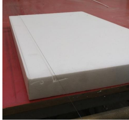
Şekil 3.23. EPS Sert köpük malzemenin CNC Router tezgahında kesimi
