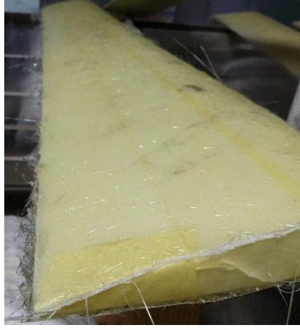
Şekil 3.27. Cam elyaf takviyeli polyester reçine kaplı kanatçıklardan birisi
