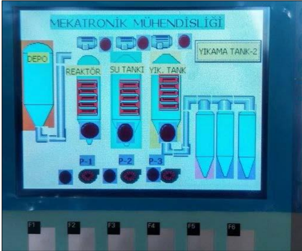
Şekil 3.7. Biyodizel tesisinin ana kumanda ekranı
