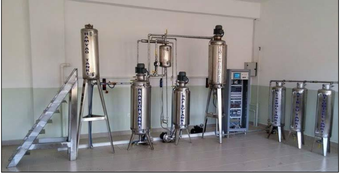
Şekil 4.1. Küçük ölçekli programlanabilir kontrol cihazı (PLC) destekli pilot biyodizel üretim tesisinin genel görünümü
