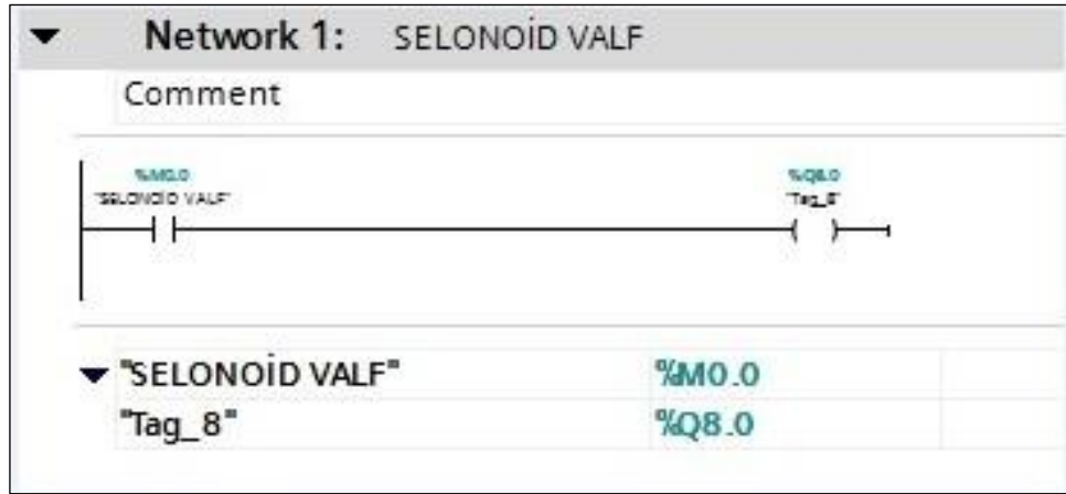
Şekil 4.4. Selenoid valfin kontrol paneline bağlantı kodları
