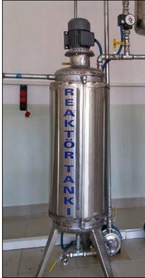
Şekil 4.8. Reaktör tankı ve karıştırıcısı üç fazlı asenkron motor
