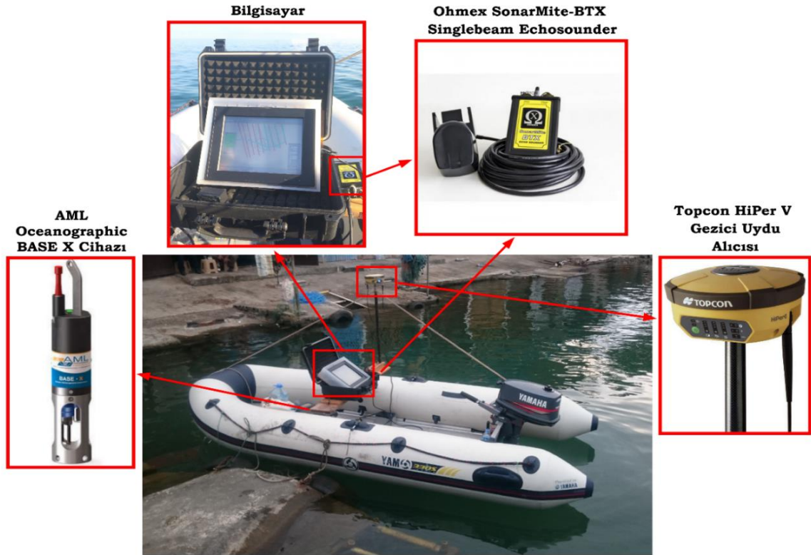
Şekil 12. Ölçümlerde kullanılan mobil bot ve bota kurulan ekipmanlar
