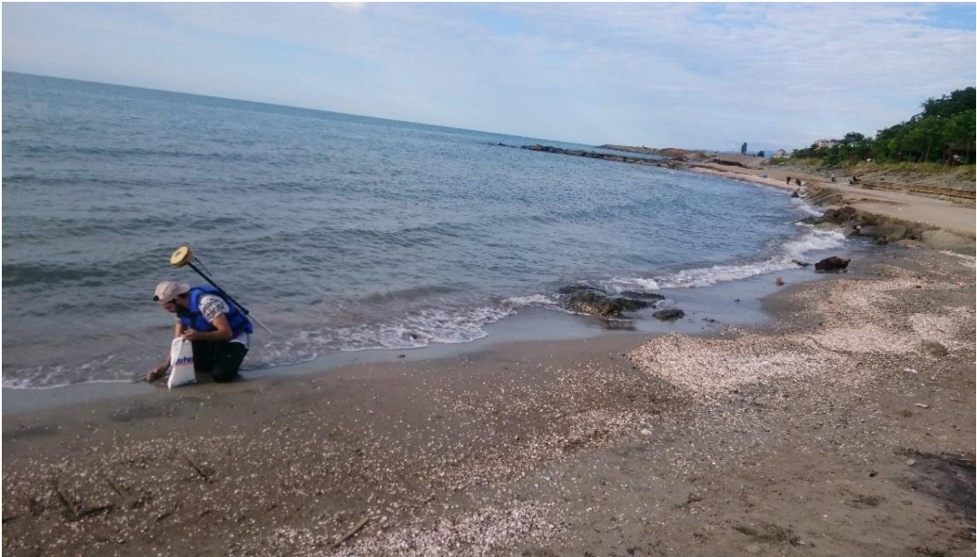
Şekil 18. Taban malzemesi numunelerinin alınması
