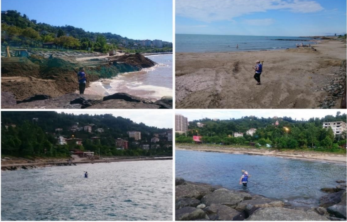
Şekil 11. Can yeleğine monte edilmiş GPS sistemi ile kara ölçümlerinin ve 1 metre derinliğe kadar deniz ölçümlerinin yapılması
