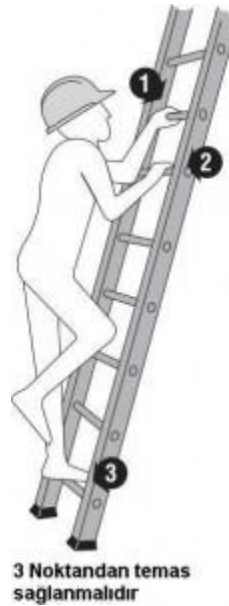
Şekil 2. Üç noktadan temas detayı (Bulut, 2020)
