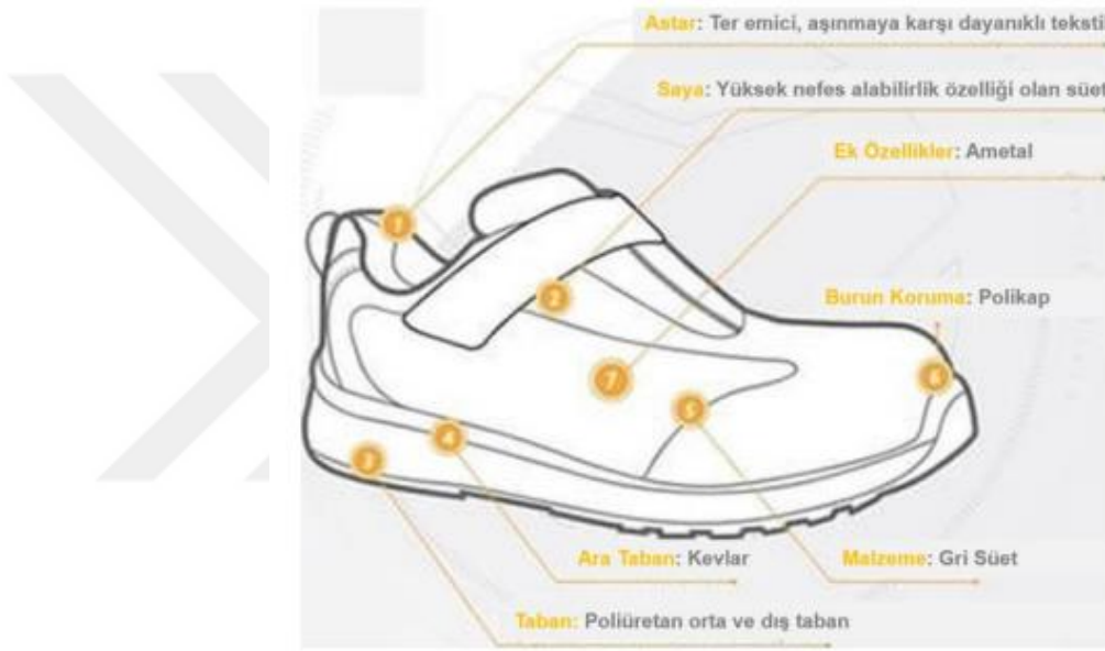
Şekil 6. İş güvenliği ayakkabısı malzeme özellikleri (STB ve GEKA, 2021)
