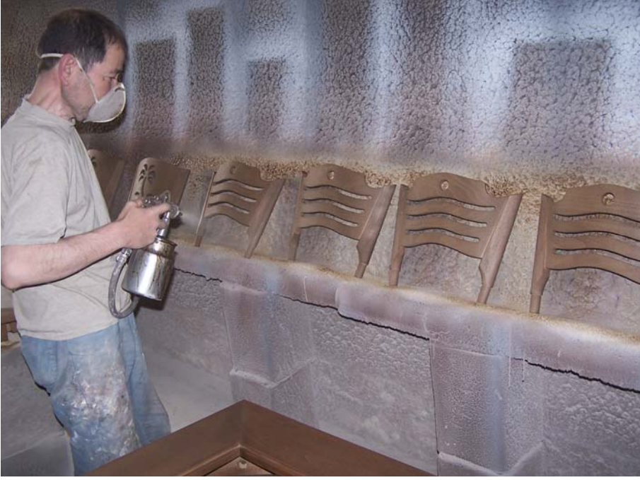
Resim 1. Duvar yüzeylerine dayandırılıp verniklenen iş parçaları
