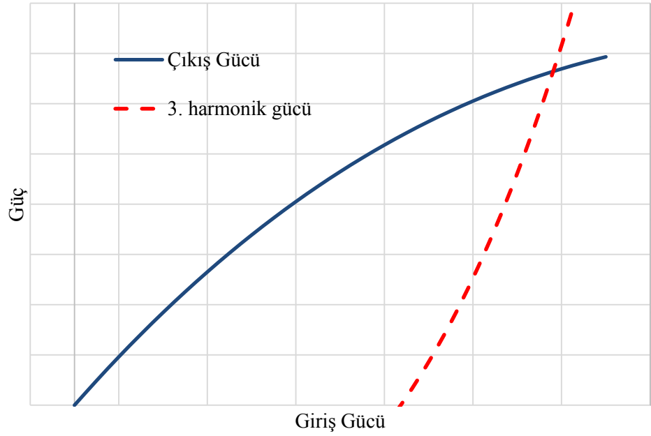
Şekil 2.14 : 3. harmonik gücü ile asıl işaret gücünün kesişmesi.
