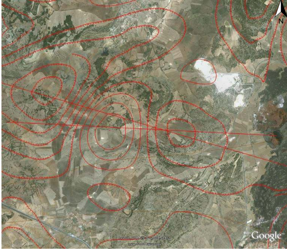
Şekil 6.28 Kula volkanına ait uydu görüntüsü ve hava manyetik anomalisi
