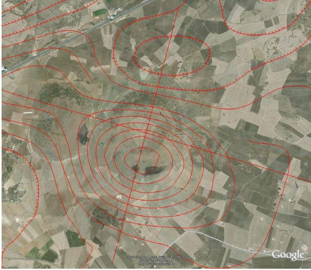
Şekil 6.30 Kula-Doğu volkanına ait uydu görüntüsü ve hava manyetik anomalisi
