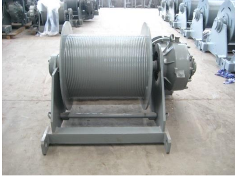
Şekil 2.34. Kule vinç halat tamburu örneği
