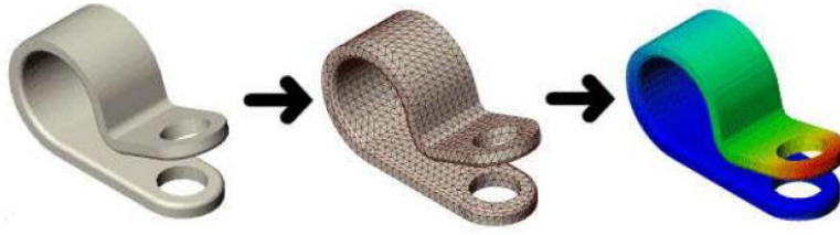
Geometrik model, Sonlu eleman modeli ve sonuçların gösterildiği nodal sonuçlar.
