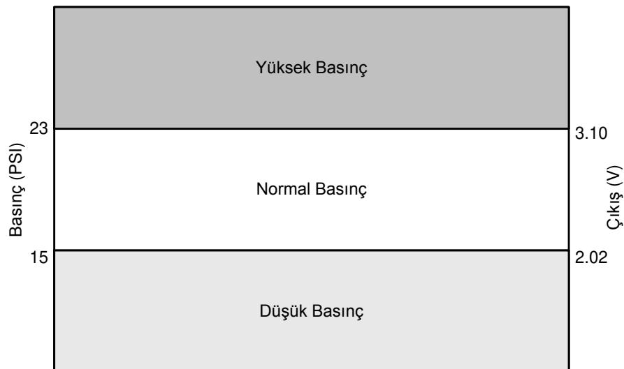
Şekil 4.12. Ürün tankındaki basıncın sınıflandırılması
