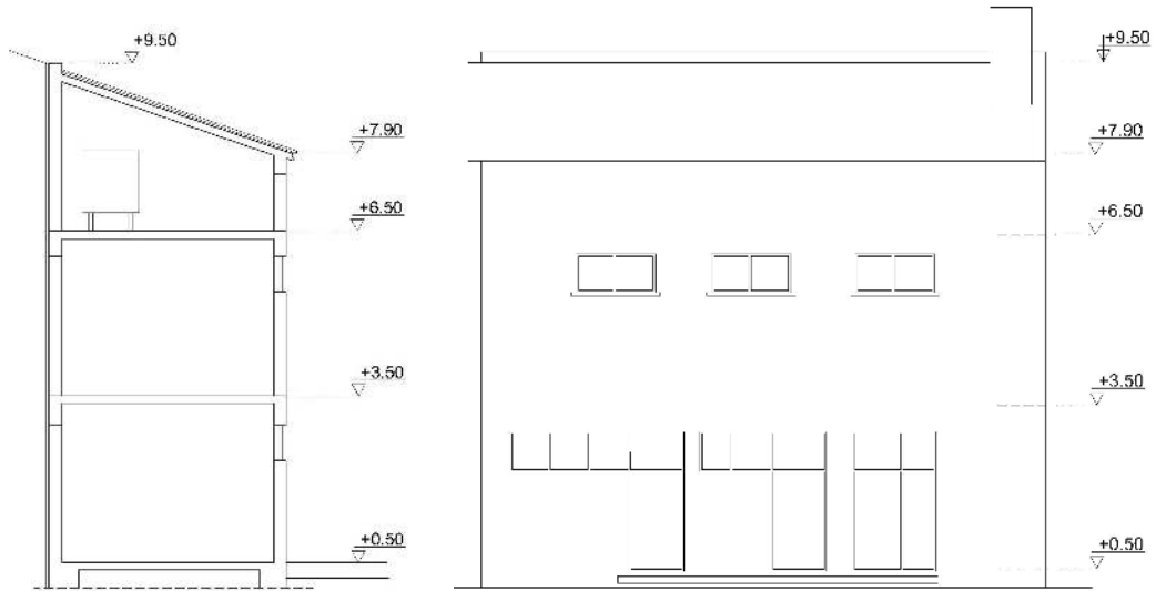
Şekil 4.44. Ordu Çok Amaçlı Salon teknik bina a-a kesiti ve ön cephe [KMDB arşivinden faydalanılarak Yusuf Seven tarafından yeniden çizilmiştir].
