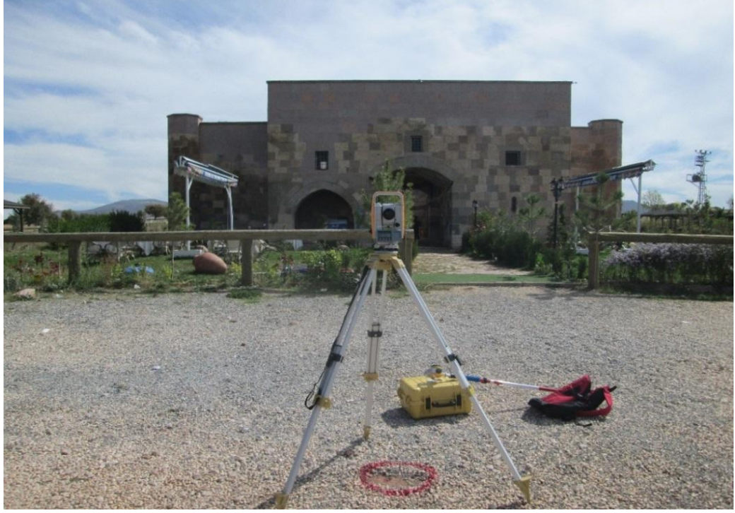
Şekil 5.2. Topcon KS-102 total station aleti.
