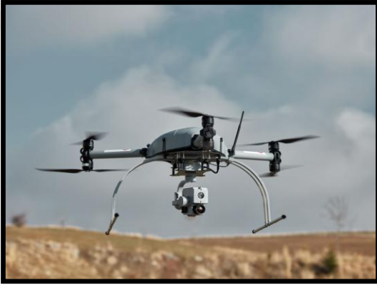
Şekil 3.2. Çok pervaneli (Muticopter) İHA örnekleri.
