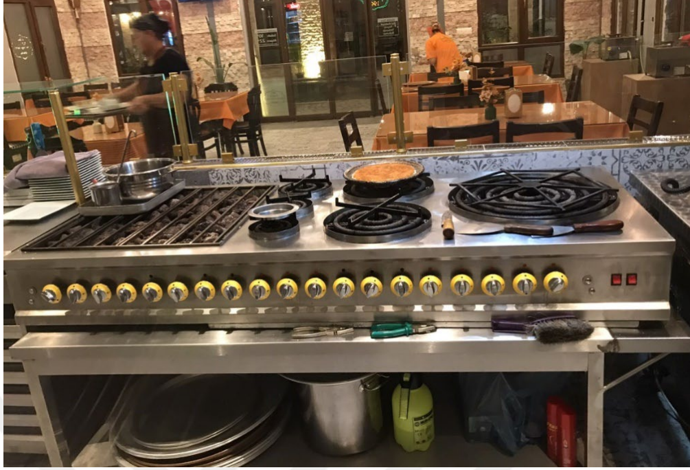
Görsel 6.32. Her bir brülör için gaz kontrolünü sağlayan düğmeler, yazar tarafından fotoğraflanmıştır.
