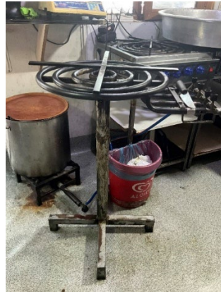
Görsel 6.29. Yarı mekanik ayaklı künefe pişirim ocağı (sağ tarafta), yazar tarafından fotoğraflanmıştır.
