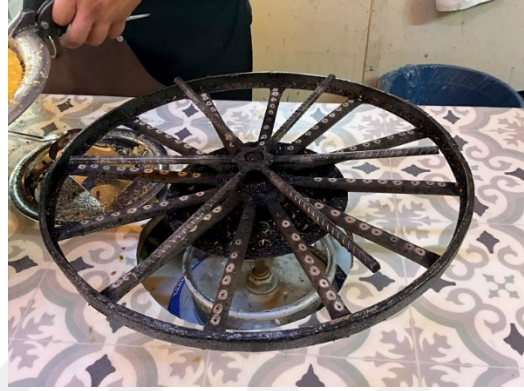
Görsel 6.28. Direkt tüp gaza bağlanan döner başlıklı tabla aparatı, yazar tarafından fotoğraflanmıştır.
