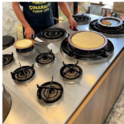
Görsel 6.29. Yarı mekanik ayaklı künefe pişirim ocağı (sağ tarafta), yazar tarafından fotoğraflanmıştır.
