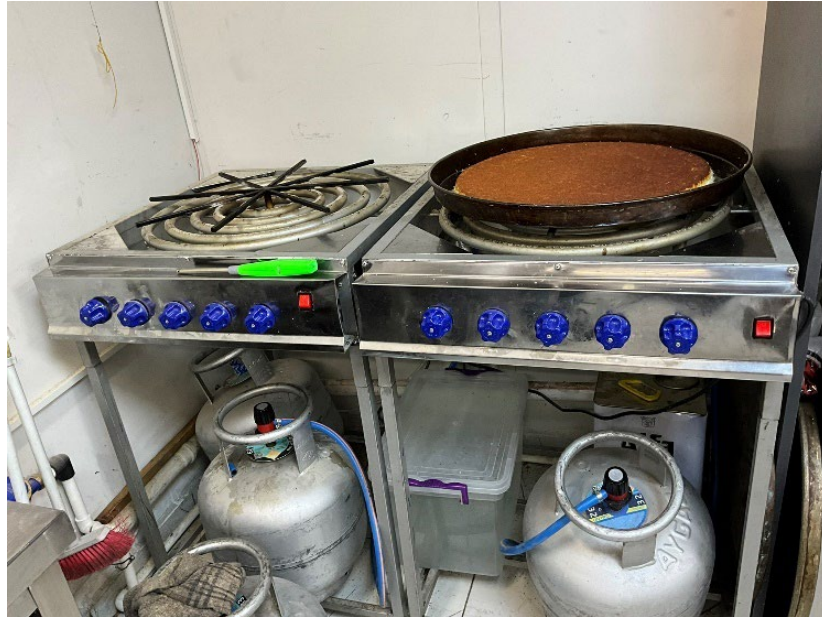
Görsel 6.27. Tüp gaz ile çalışan künefe ocağı, yazar tarafından fotoğraflanmıştır.
