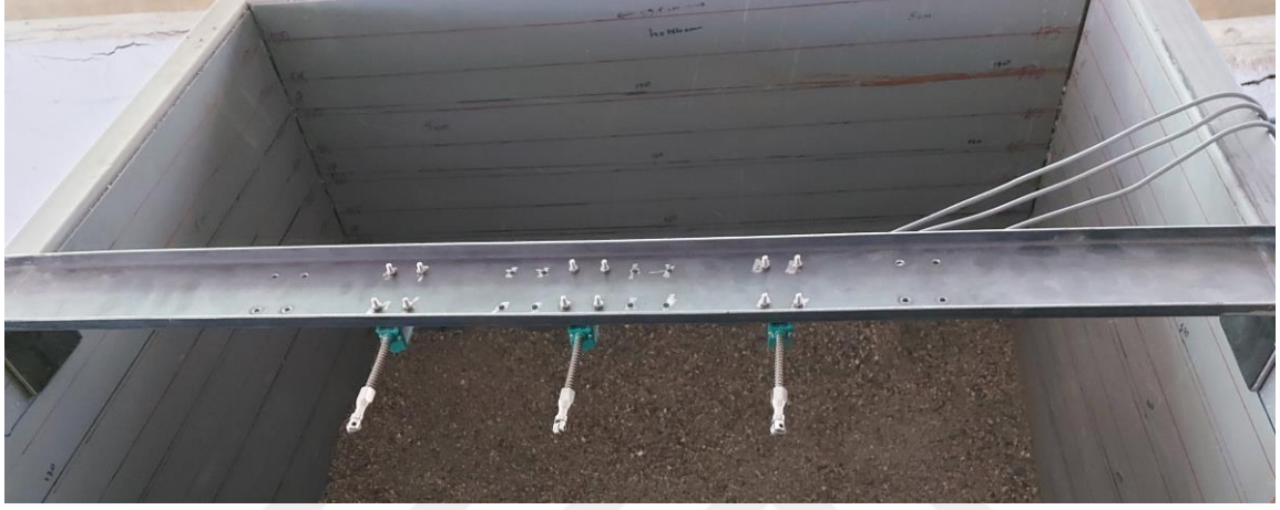
Şekil 21. LVDT'lerin yatay olarak yerleştirildiği plaka
