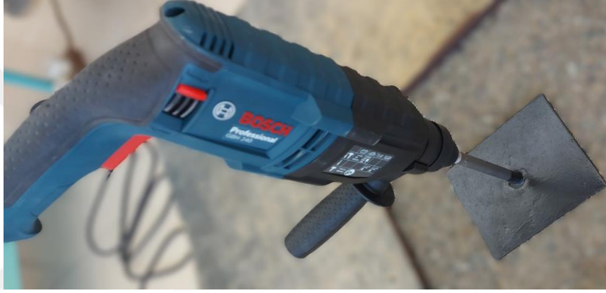
Şekil 24. Sıkıştırma işlemi için kullanılan kompaksiyon cihazı
