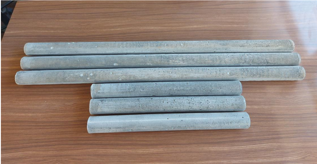
Şekil 18. Deneylerde kullanılan model kazıklar
