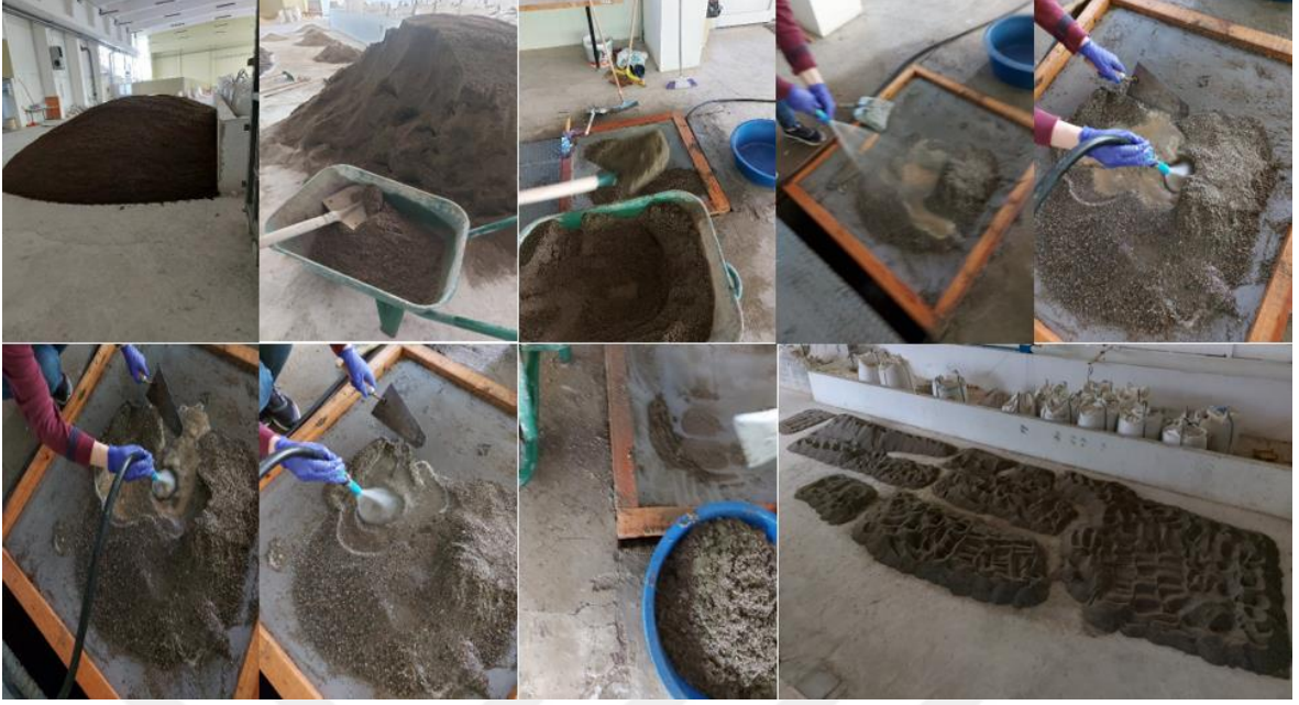
Şekil 25. Deneylerde kullanılan kumun yıkanması ve kurutulması
