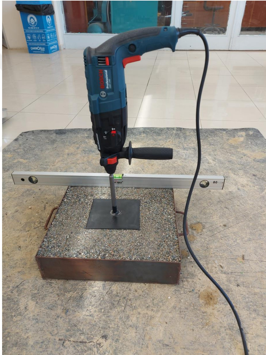
Şekil 29. Sıkı haldeki kum zemin için kuru birim hacim ağırlığının belirlenmesi
