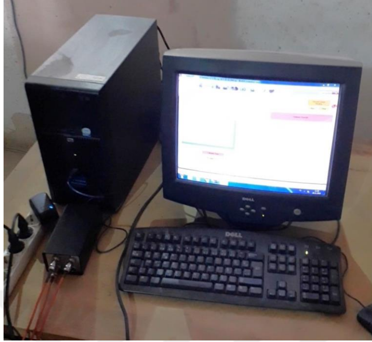
Şekil 22. Veri toplayıcı-DATALOGGER ünitesi
