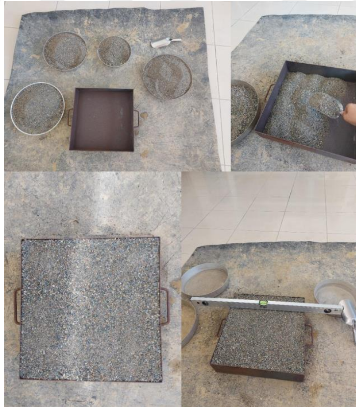
Şekil 28. Gevşek haldeki kum Zemin için kuru birim hacim ağırlığının belirlenmesi
