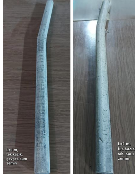
Şekil 34. Yatay yüke maruz L=1 m olan kazığın davranışı (b) gevşek ve sıkı kum zeminde kazığın deney sonrası fotoğrafları
