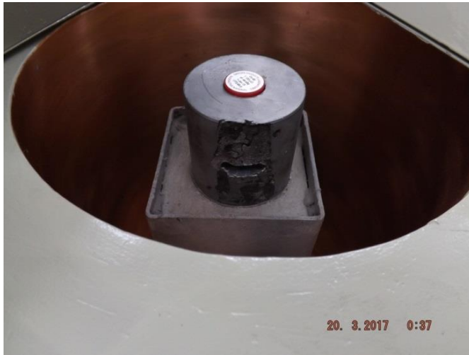
Şekil 0.45 Soğurma düzeneği ve numune değiştirme gözü
