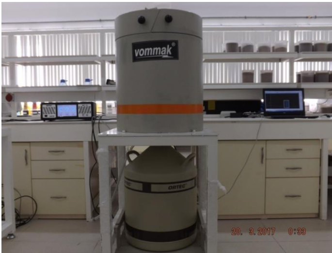
Şekil 0.43 Ametek-Ortec marka HpGe gama dedektör sistemi
