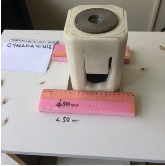
Şekil 0.40 KTÜ Fen Fakültesi'nde bulunan soğurma ölçümleri için kullanılan kolimatör
