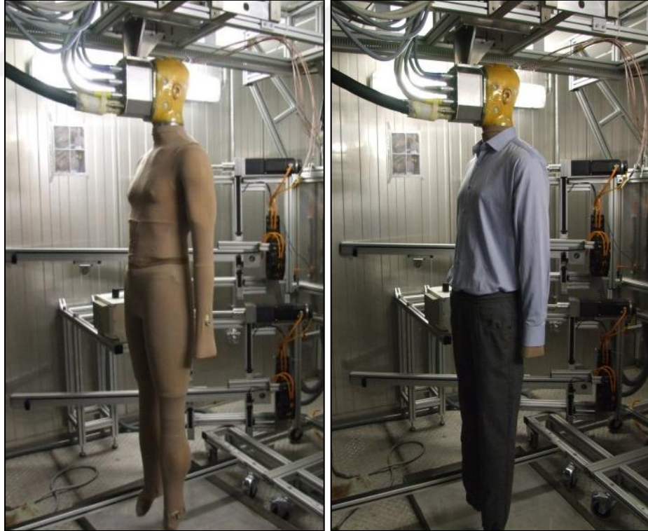
Şekil 2.13 Terleyen termal manken “SAM” kullanılarak giysi kombinasyonlarının ısı ve sıvı transferinin ölçümü
