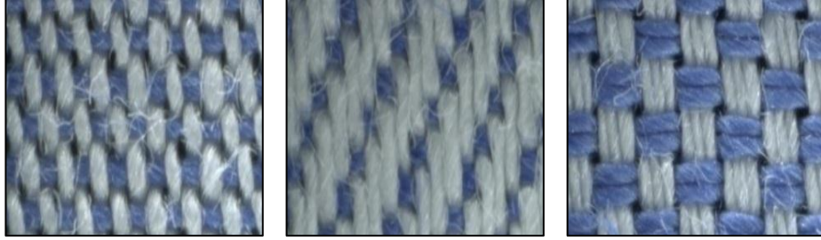
Şekil 2.1 Dokuma kumaşlarda kullanılan örgü tipleri (Bezayağı, 3/1 dimi ve panama türevi)
