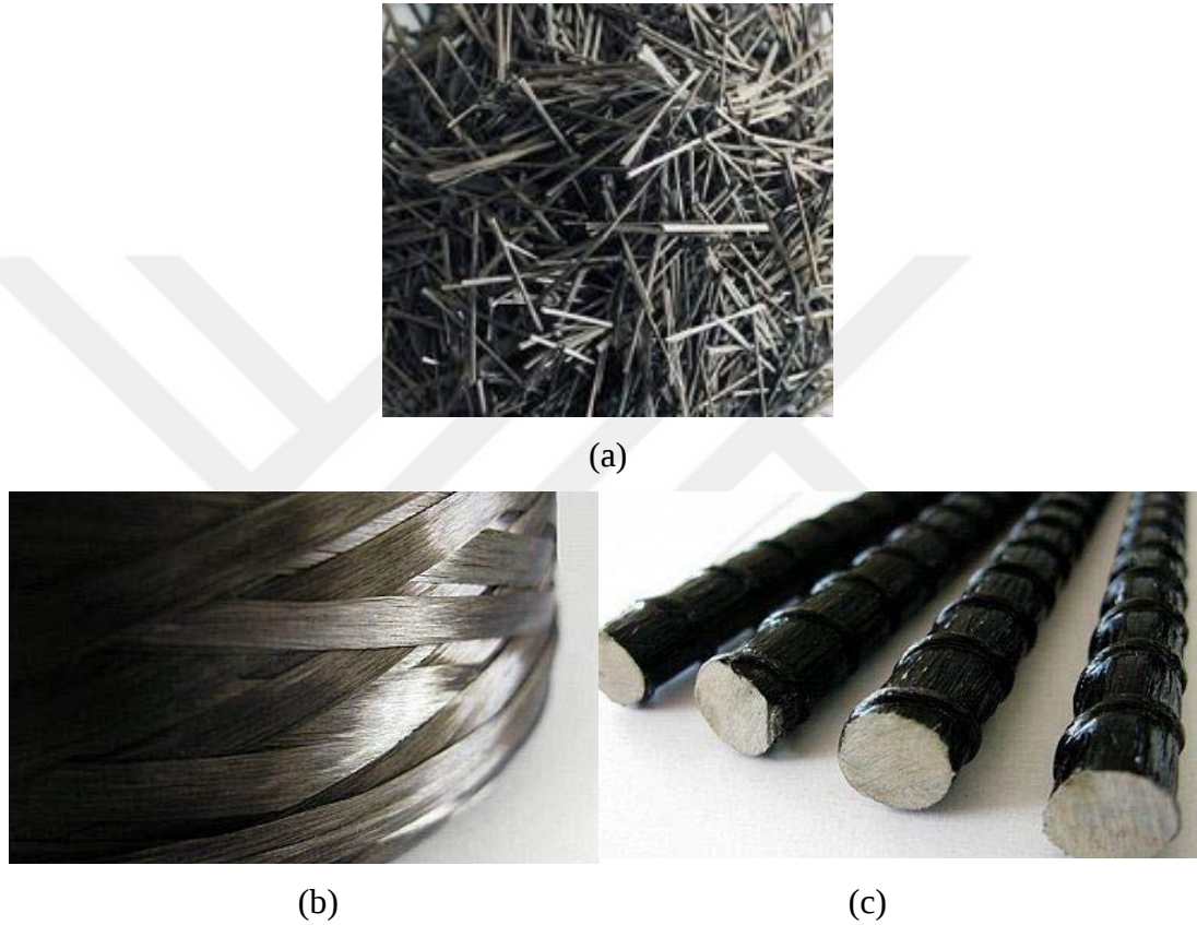
Şekil 3.2. Bazalt fiberin farklı formları (a) kırılmış bazalt fiber, (b) bazalt ip, (c) bazalt çubuklar (Çevik ve Haldenbilen, 2014; Dostkimya, 2022).
