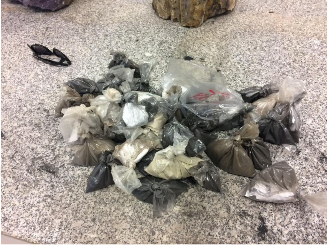
Şekil 3.15. Öğütüldükten sonra analize hazır olan numunelerin görüntüsü
