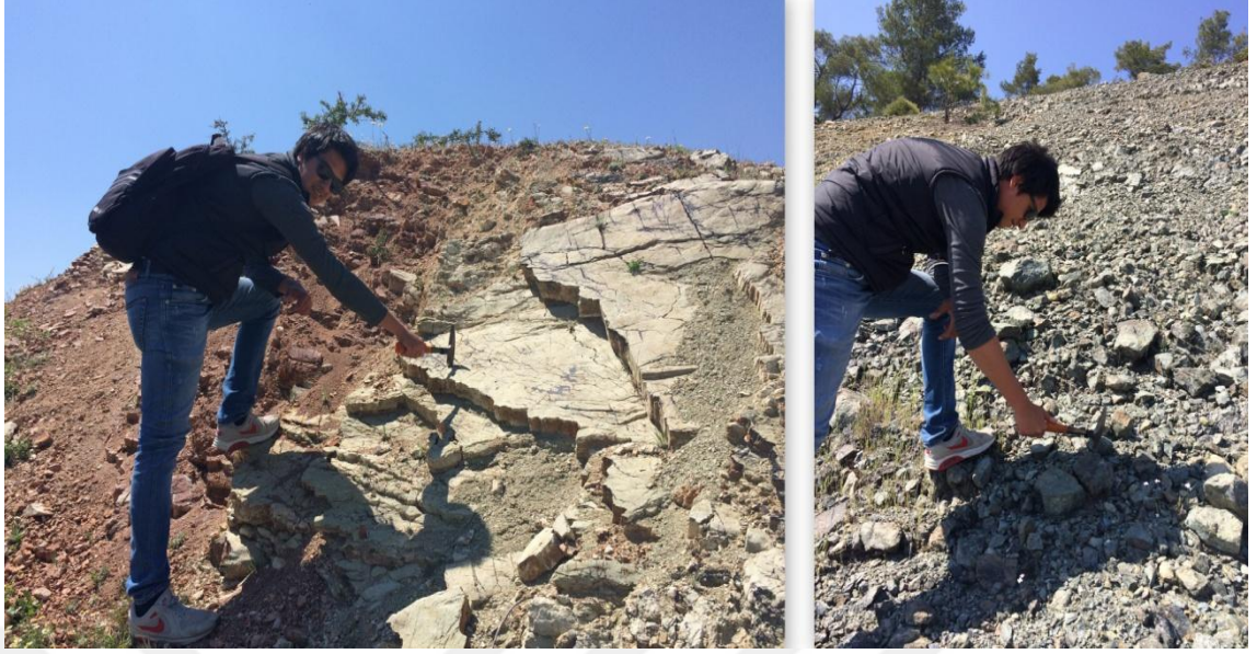
Şekil 3.8. Arazide jeolog çekici yardımıyla numune alma işlemi
