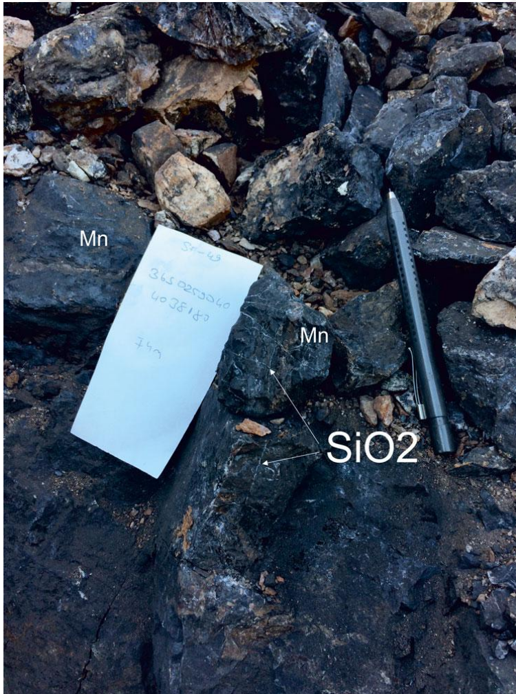
Şekil 4.7. Asmad madenciliğe ait mangan ocağından alınan ince kuvars damarlı mangan numunesinin görünümü
