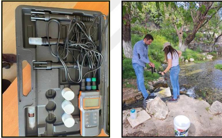
Şekil 3.5. Combo Water Quality Meter cihazı ve ölçüm çalışması
