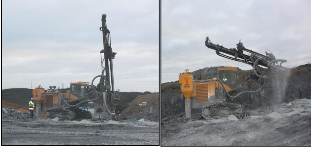
řekil 2.1: Deliklerin delinmesinde kullanılan delici makine.
