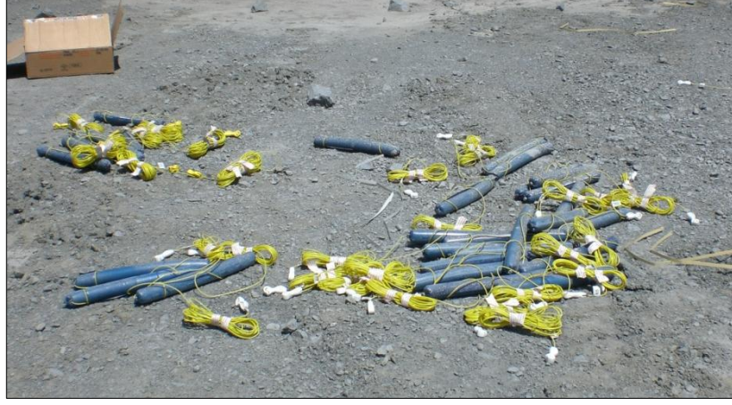
Şekil 2.7: Yemleme olarak kullanılan kapsül bağlanmış emülsiyon
