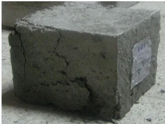
ekil 3.44. Bir gözlem numunesinin k,r,lma, halinin yak,n görüntüsü
