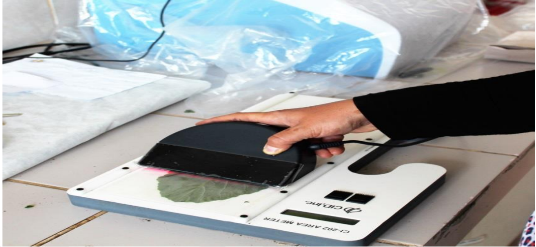
Şekil 3.7. Yaprak alan ölçümü (orijinal)
