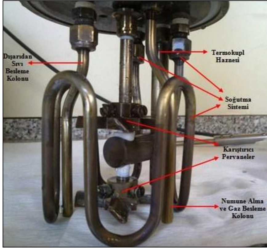
Şekil 3.5 Reaktör sisteminin üst tarafında bulunan kapak bölümüne monte edilmiş ve liç kabı içerisine kadar uzanan ekipmanlar
