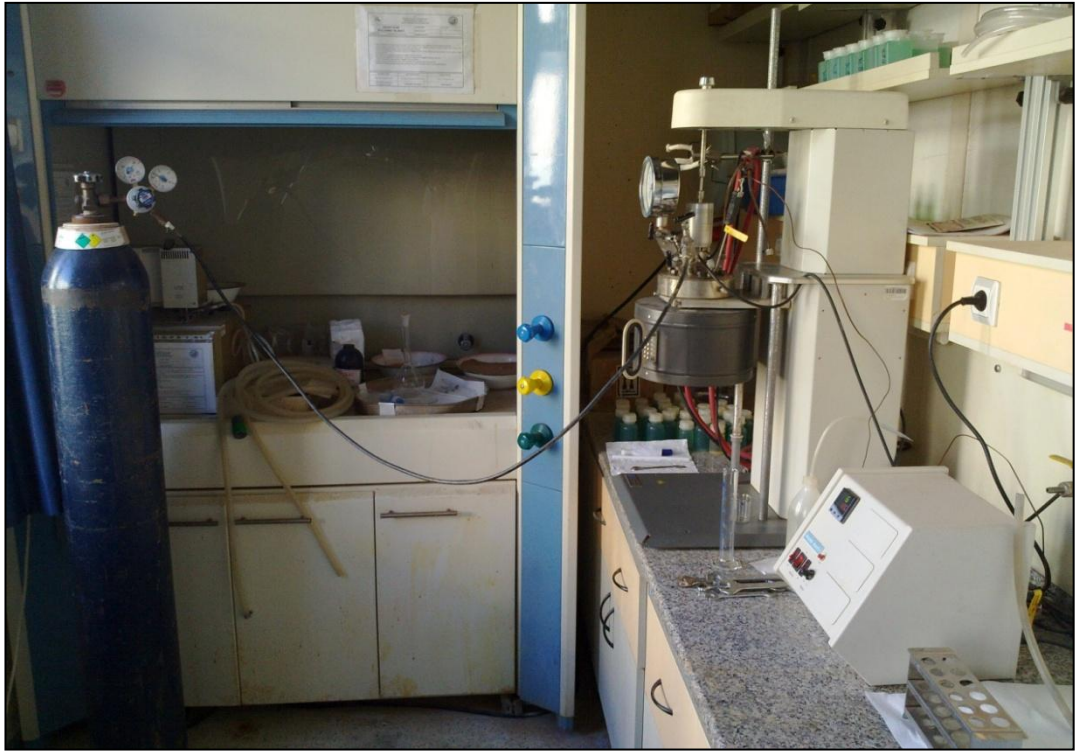
Şekil 3.8 Basınç liçi çalışmalarının uygulandığı deney sistemi
