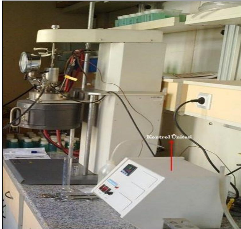
Şekil 3.7 Sıcaklık ve manyetik karıştırıcının kontrolünü sağlayan kontrol ünitesi
