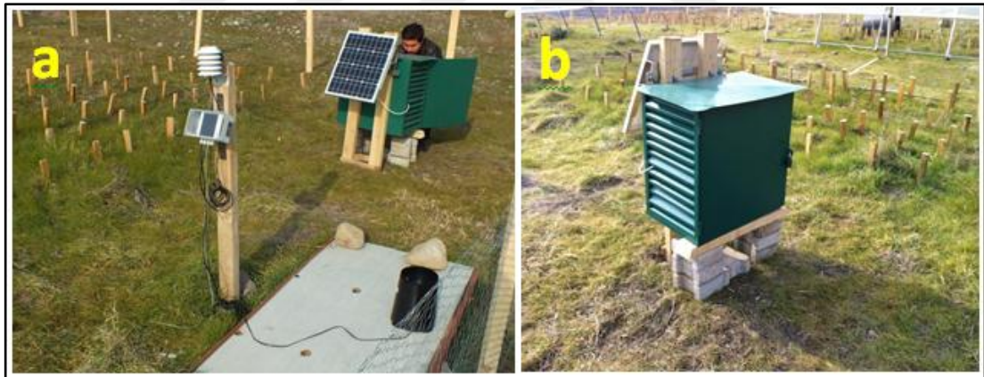
Şekil 3.6. a) Arazi alanına iklim ölçer aletlerin montajı; b) Veri transfer cihazı ve korunması için demir kılıf
