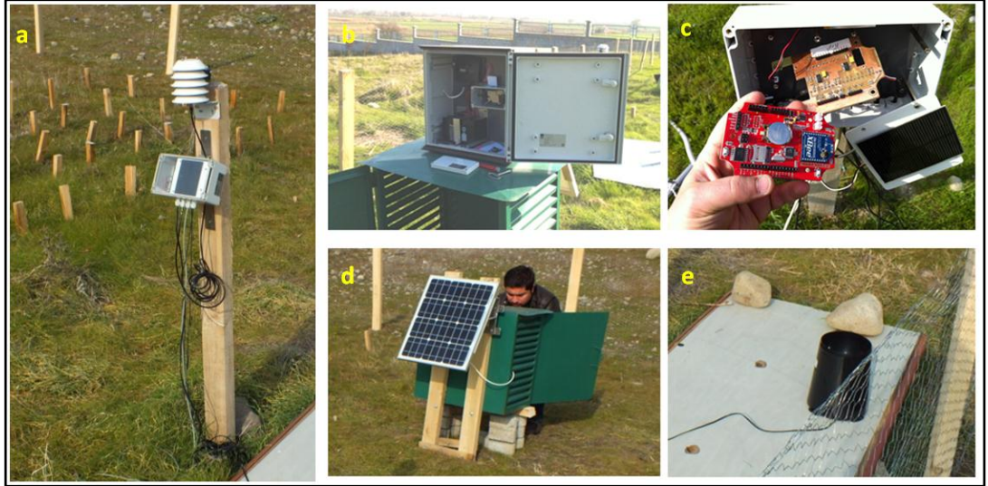
Şekil 3.29. a) C4 bloğunun yanına sabitlenen sıcaklık ve toprak nemi ölçer ile kaydedicisi, b) Veri transfer cihazının iç yapısı; c) Toplanan iklimsel verilerin kayıt edilmesini sağlayan mikroçip içeren cihaz; d) Sistemin çalışması için enerjisini sağlayan güneş paneli; e) Toprak yüzeyine paralel olarak sabitlenen yağış ölçer
