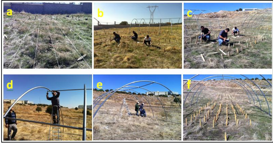
Şekil 3.5. a) Deney alanının hassas bir ölçüm ile belirlenmesi; b,c) Tahta takozların arazi alanına monte edilmesi; d,e) Sera demirlerinin üç blok üzerine monte edilmesi; f) Arazinin deneye hazır hale getirilmesi
