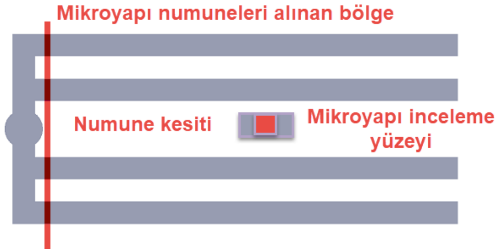
Şekil 27. Mikroyapı numunesi alınan bölgelerin gösterilmesi.
