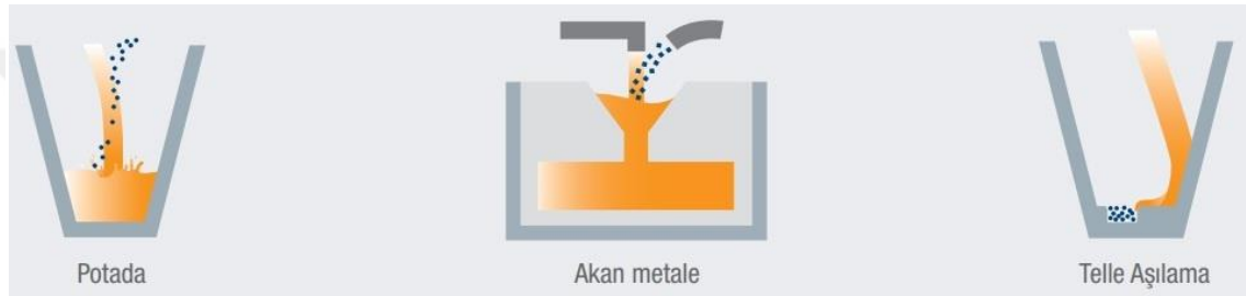
Şekil 10. Aşılama yöntemlerinin şematik görünümü
