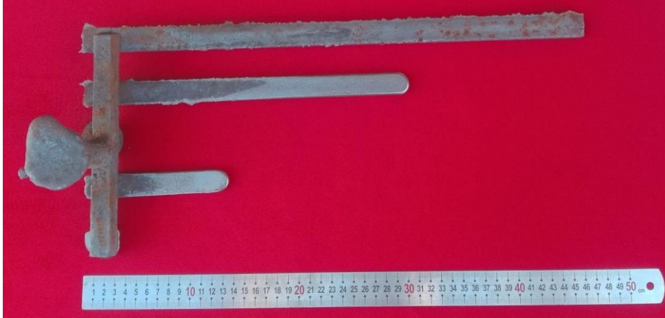
Şekil 37. 1350 °C sıcaklık, %10 metalürji kalitesi, 5 sn dolun hızı şartlarındaki döküm.
