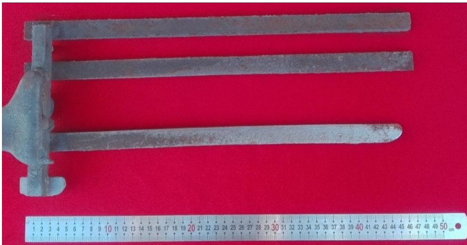
Şekil 43. 1400 °C sıcaklık, %50 metalürji kalitesi, 10 sn dolun hızı şartlarındaki döküm.
