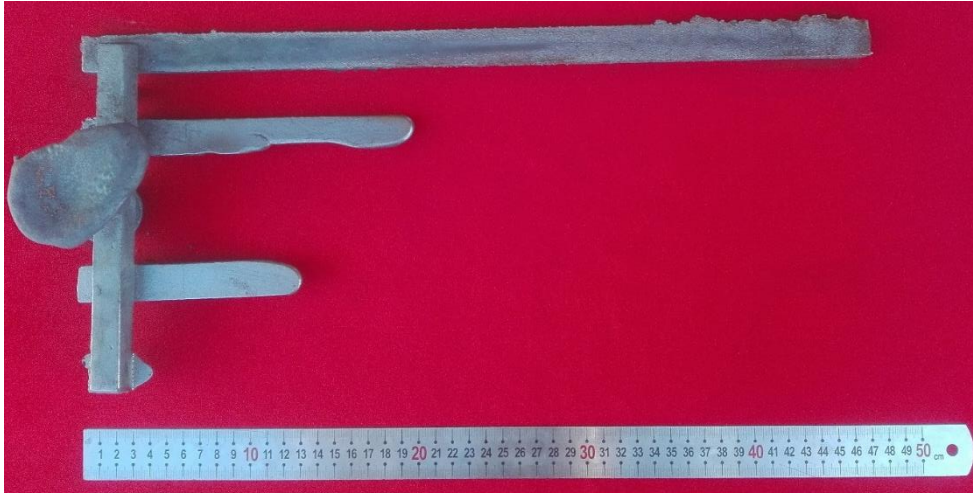
Şekil 38. 1350 °C sıcaklık, %10 metalürji kalitesi, 10 sn dolun hızı şartlarındaki döküm.
