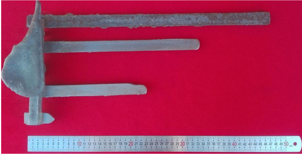
Şekil 42. 1350 °C sıcaklık, %90 metalürji kalitesi, 10 sn dolun hızı şartlarındaki döküm.
