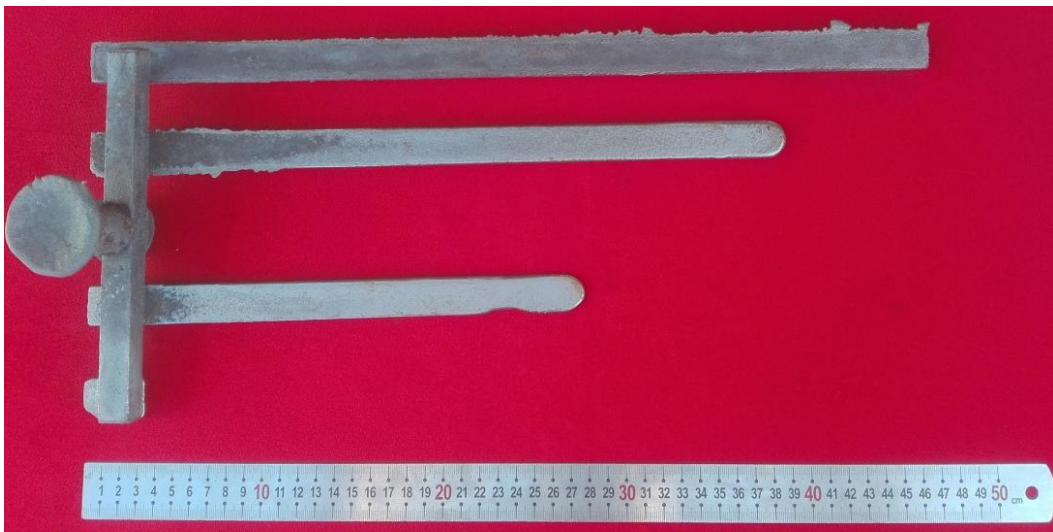
Şekil 41. 1350 °C sıcaklık, %90 metalürji kalitesi, 5 sn dolun hızı şartlarındaki döküm.
