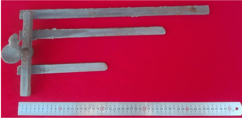
Şekil 40. 1350 °C sıcaklık, %50 metalürji kalitesi, 10 sn dolun hızı şartlarındaki döküm.
