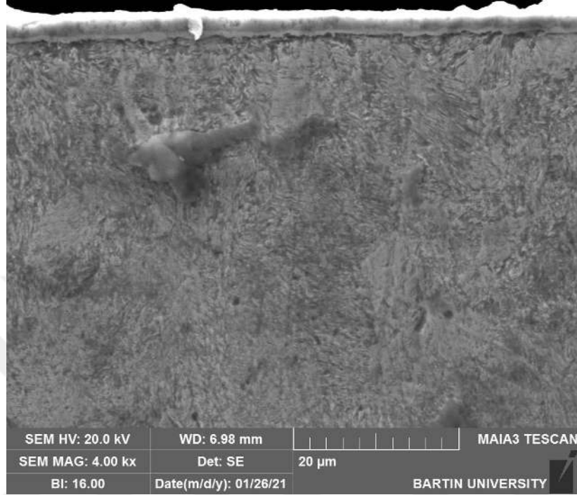
Şekil 4.13. 900 °C Sıcaklıkta 2 Saatte Oluşturulan VC Kaplamanının SEM Görüntüsü
