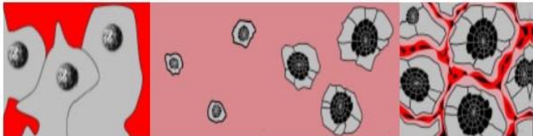
Şekil 4.5. Birinci çekirdekleşme ve grafit büyümesi
