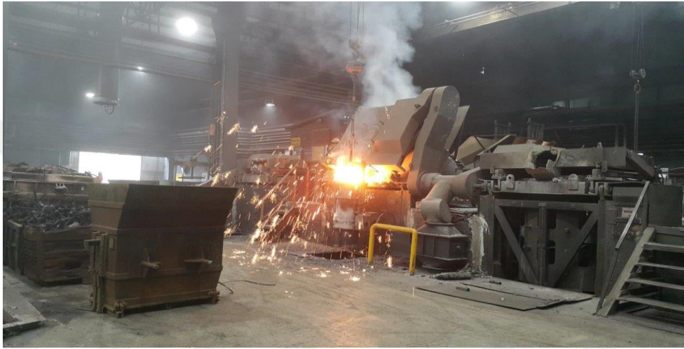
Resim 5.2. Sıvı metalin ocaktan potaya aktarılması işlemi (tretman işleminin başlangıcı).
