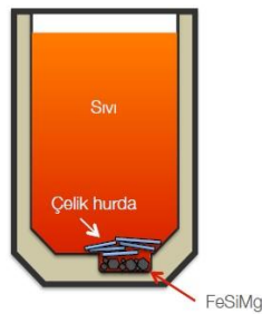
Şekil 3.17. Sandviç yönteminin şematik gösterimi
