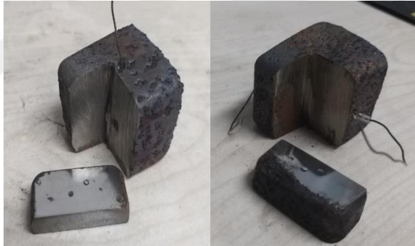
Resim 5.29. Numunelerden kesilen kesitler (1 ve 5' nolu numuneler mikroyapı ve sertlik incelemesi için).
