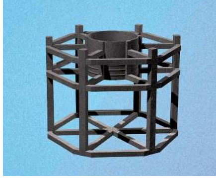
Şekil 4.18 Kapasitesi arttırılmış temel iskeleti (Ties Rijcken)
