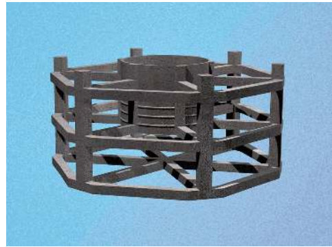
Şekil 4.17 Çelik kalıp kaldırıldıktan sonra ortaya çıkan petek şeklindeki beton temel iskeleti (Ties Rijcken)
