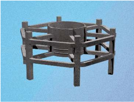
Şekil 4.17 Çelik kalıp kaldırıldıktan sonra ortaya çıkan petek şeklindeki beton temel iskeleti (Ties Rijcken)
