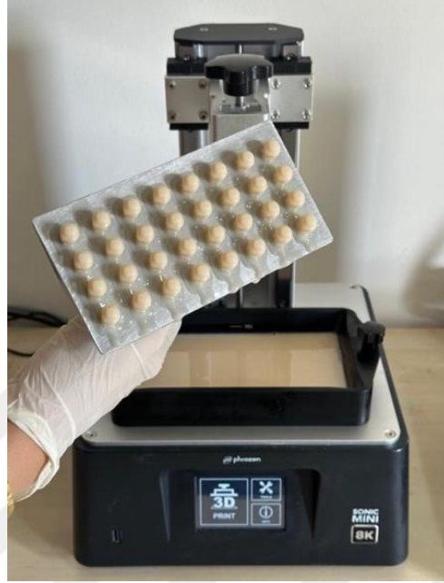
Şekil 3.3. 3B Yazıcı ile Endokronların Üretim Aşaması
